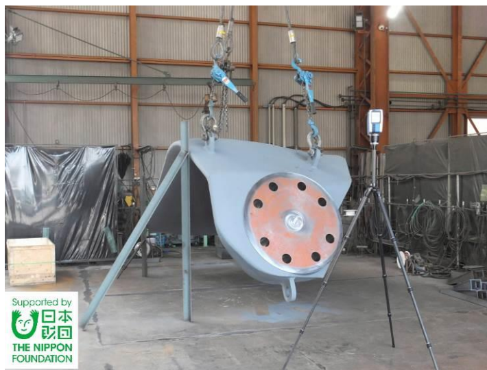
写真 5-2-2-2 3D レーザ計測の様子
