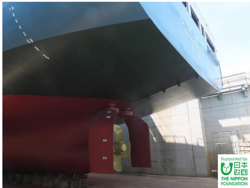
写真 5-6-2 ゲートルダー搭載後の様子
