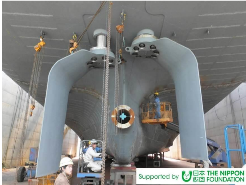
写真 5-6-1 ゲートルダー搭載作業中の様子
