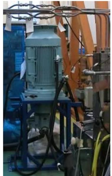
図 4. 2. 2-4 単体試験装置（左：蓄圧ブロック、右：電動油圧ポンプ）
