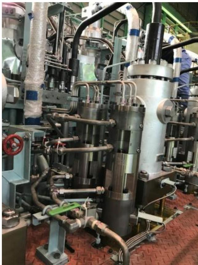
図 4. 2. 1-7 燃料噴射ポンプ、注水ポンプ
