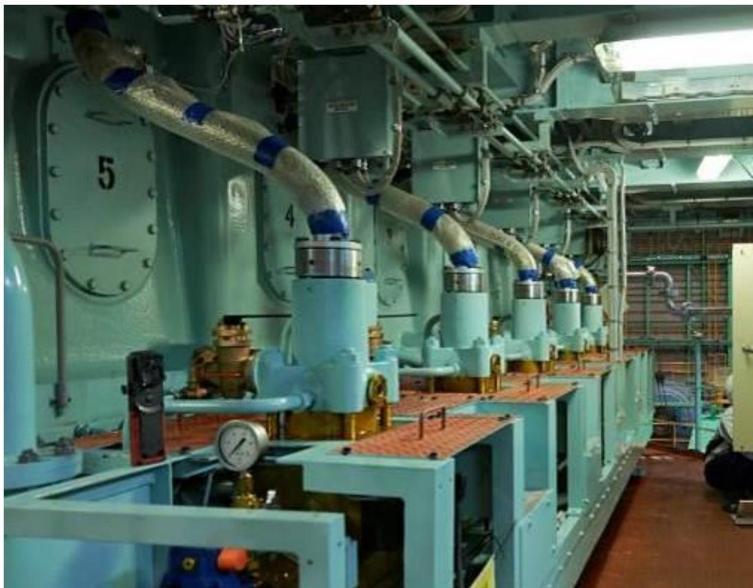
図 4. 2. 1-9 中段 下部動弁装置配置
