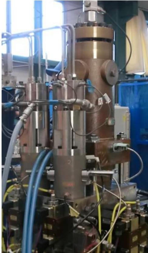
図 4. 2. 2-3 単体試験装置（手前：注水ポンプ、奥：燃料噴射ポンプ）
