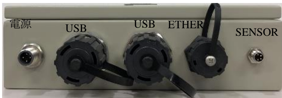
図 3-12 振動・傾斜記録装置 インターフェース部写真
