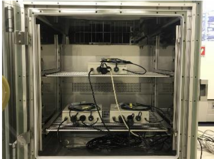
図 3-24 振動・傾斜記録装置 温度測定環境写真
