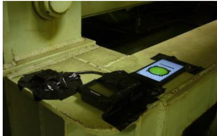
図 7-40 実貨物（リフトブルカー）への加速度ロガーと水平水準計取り付け
