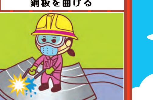
船って、曲線の部分があるよね。機械や手作業で鋼板を曲げていくよ。火と水を使って鉄を曲げる「gyo-iron」は、日本で開発されたスゴイ職人技なの！
