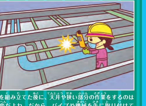
船を組み立てた後に、天井や狭い部分の作業をするのは大変だよね。だから、パイプや機械を先に取り付けておくよ。効率良く作業できるように工夫しているんだね！
