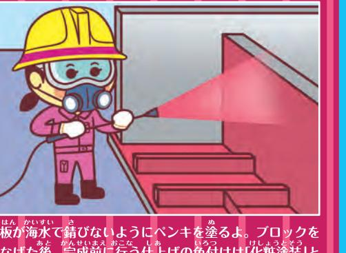
鋼板が海水で錆びないようにベンキを塗るよ。ブロックをつなげた後、完成前に上塗りする「化粧塗装」というんだ。
