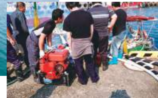
消防ポンプを使用し排水作業
