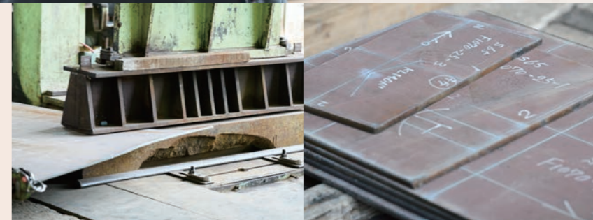
鉄板を曲げる
