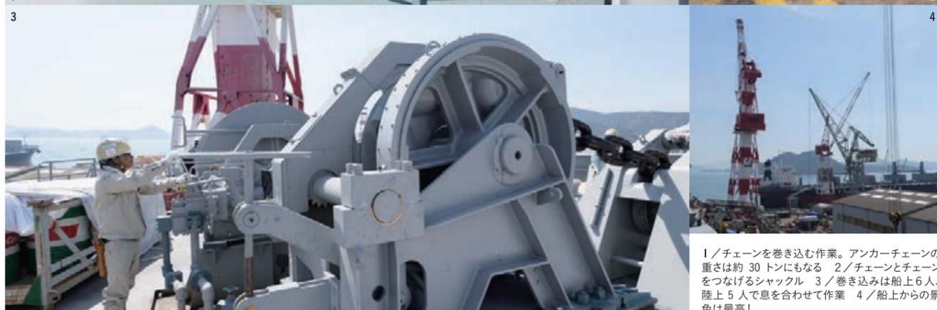
1 / チェーンを巻き込む作業。アンカーチェーンの重さは約 30 トンにもなる 2 / チェーンとチェーンをつなげるシャックル 3 / 巻き込みは船上6人、陸上 5 人で息を合わせて作業 4 / 船上からの景色は最高！
