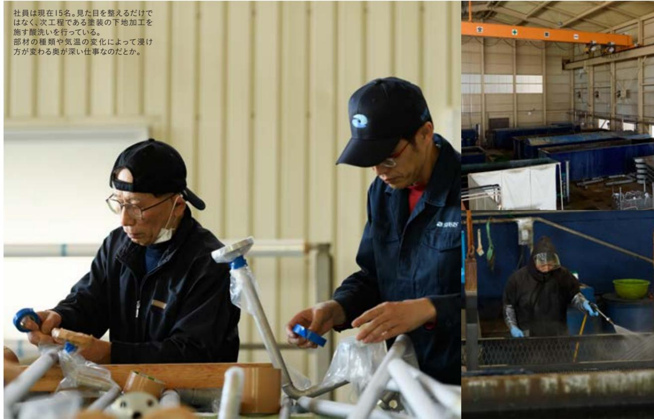
社員は現在15名。見た目を整えるだけではなく、次工程である塗装の下地加工を施す酸洗いをしている。部材の種類や気温の変化によって浸け方が変わる奥が深い仕事なのだとか。
