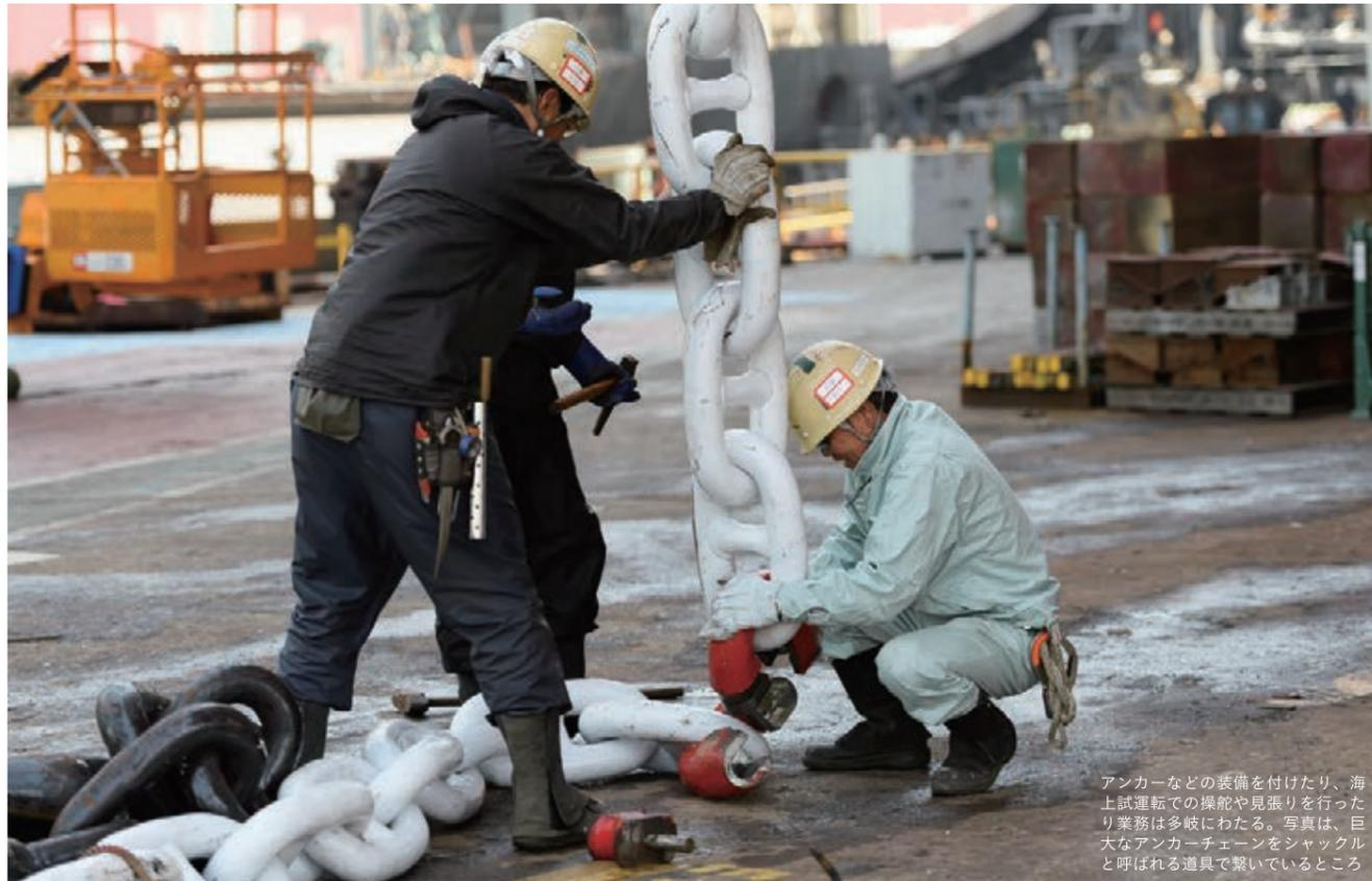
アンカーなどの装備を付けたり、海上試運転での操舵や見張りを行ったり業務は多岐にわたる。写真は、巨大なアンカーチェーンをシャックルと呼ばれる道具で繋いでいるところ
