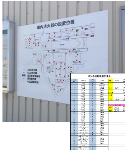
場内消火器の管理例
