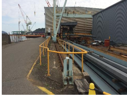
人が立ち入らないための物理的対策と巻き込まれ防止の安全装置設置例
