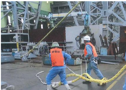
救命胴衣を着用した係船作業の例
