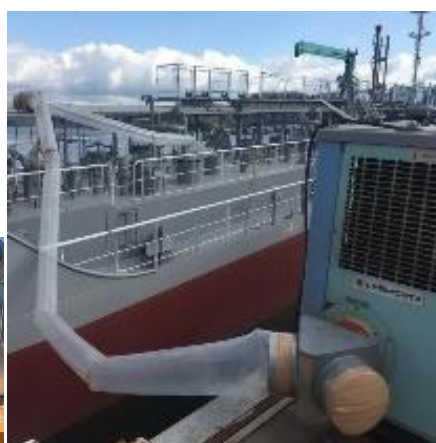
分岐管、レジャーサ管を用いた換気の場合
