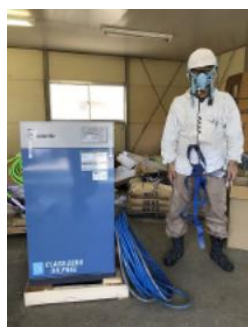
エアラインマスクと専用のコンプレッサーを導入している事例
