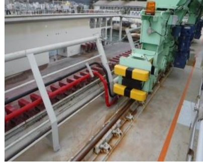
人が立ち入らないための物理的対策と巻き込まれ防止の安全装置設置例
