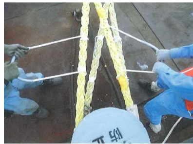
挟まれ対策を施した係船ロープの例
