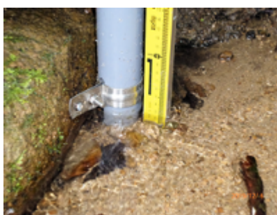
写真7 水位計設置個所の詳細
