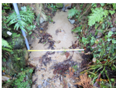
写真6 水位計(塩ビパイプ内に収納)
