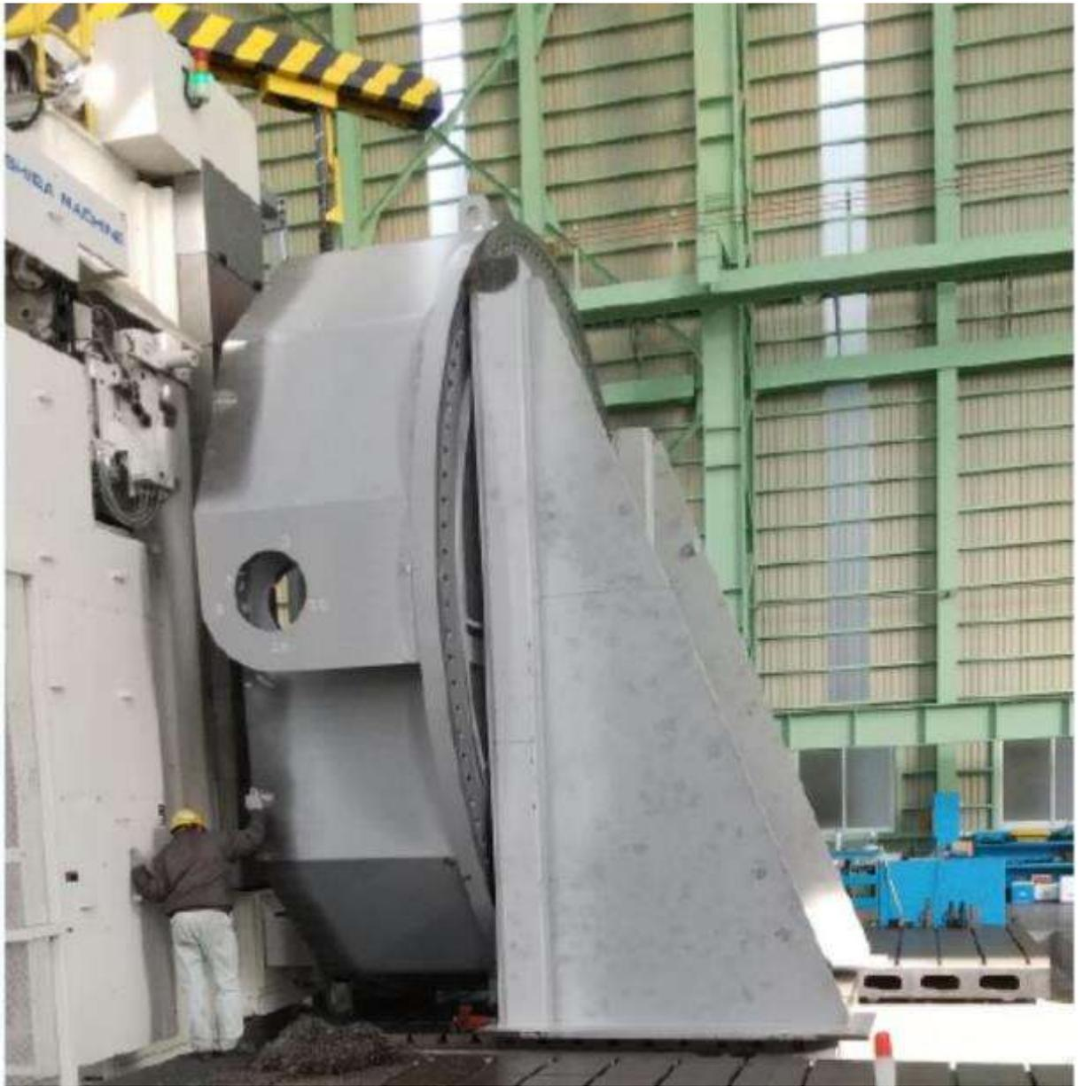
図 40. クレーン底板部機械加工
