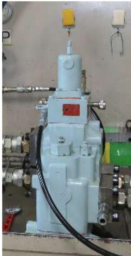
図 9. 試作した高圧電磁比例制御弁
