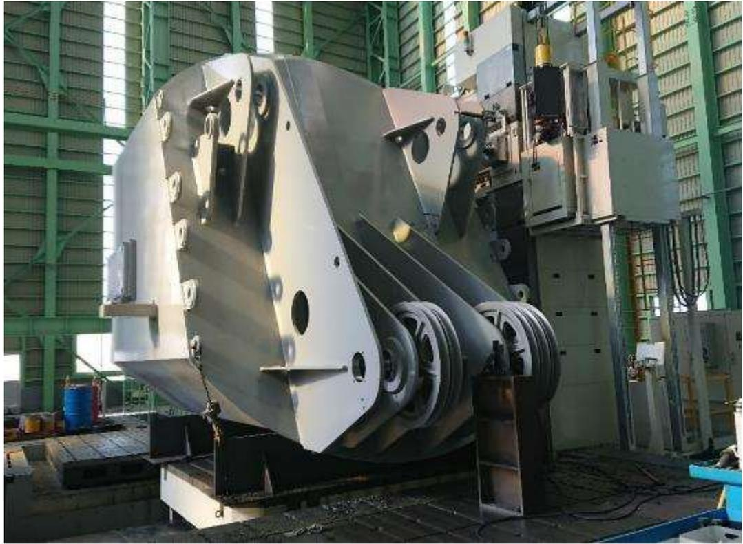
図 43. ハウストップ一体機械加工
