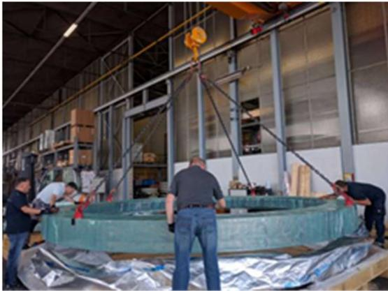
図 32. 旋回ベアリング
