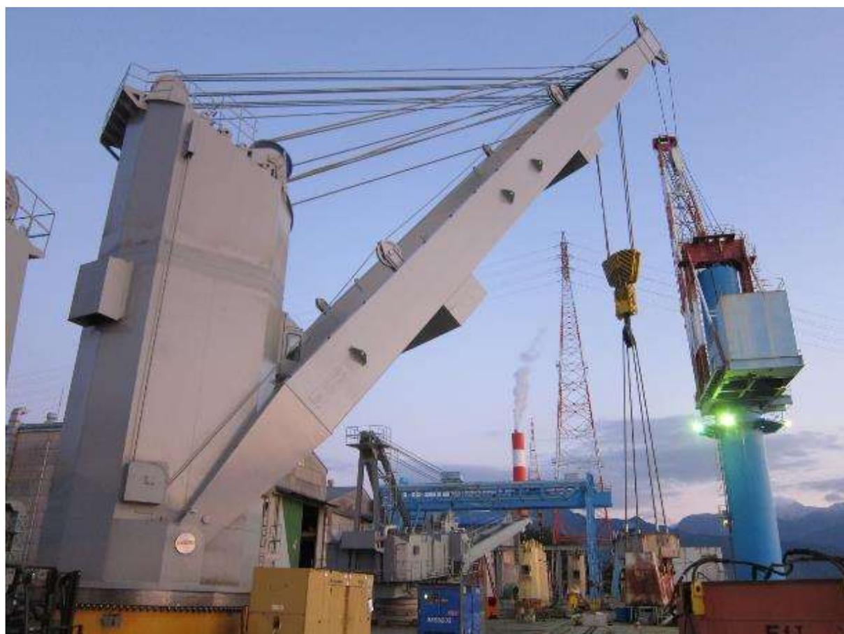
図 52. 荷重試験の様子 (50 トン)
