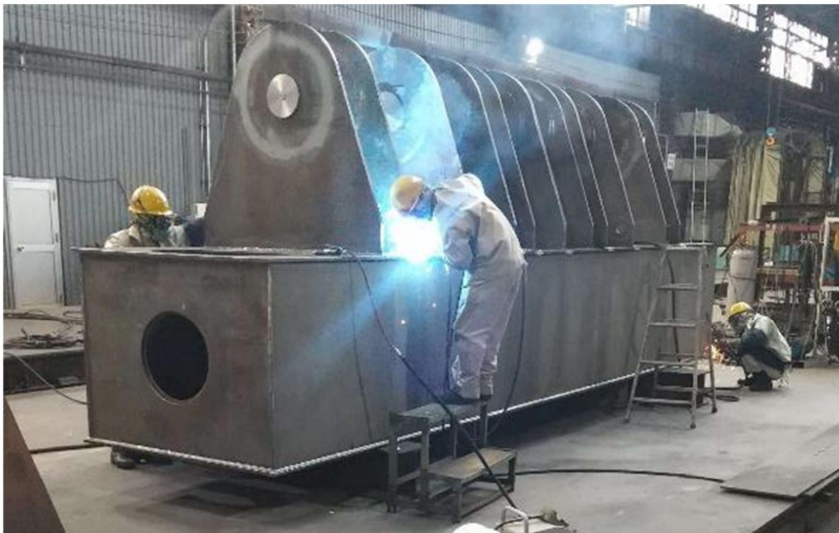
図 41. ジブトップ製缶溶接
