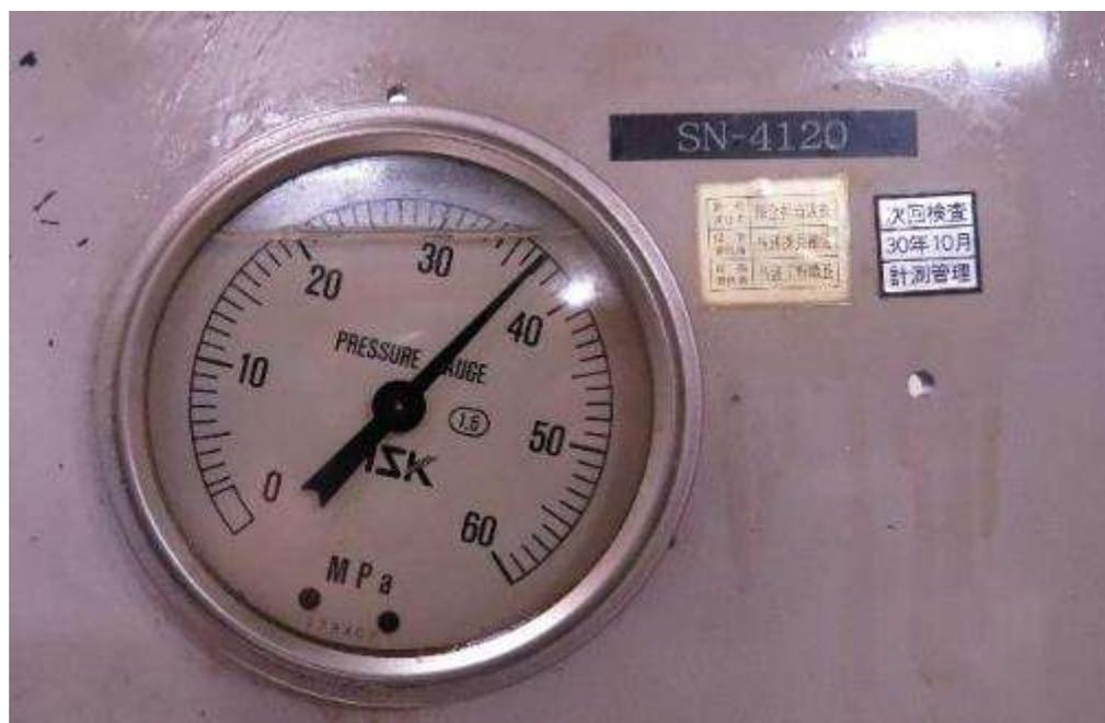
図 14. 圧力計写真(36.8MPa $\approx$ 375kg/cm<sup>2</sup>)
