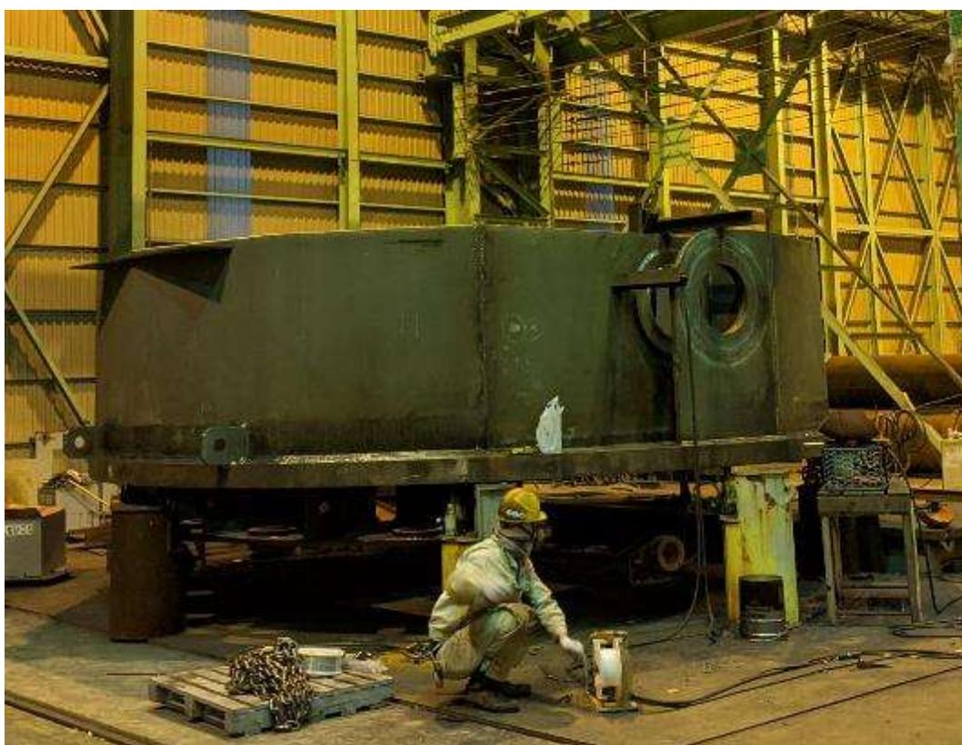
図 39. クレーン底板製缶溶接
