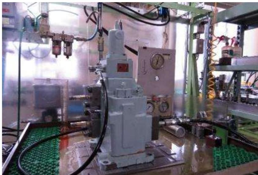
図 12. 耐圧試験状況
