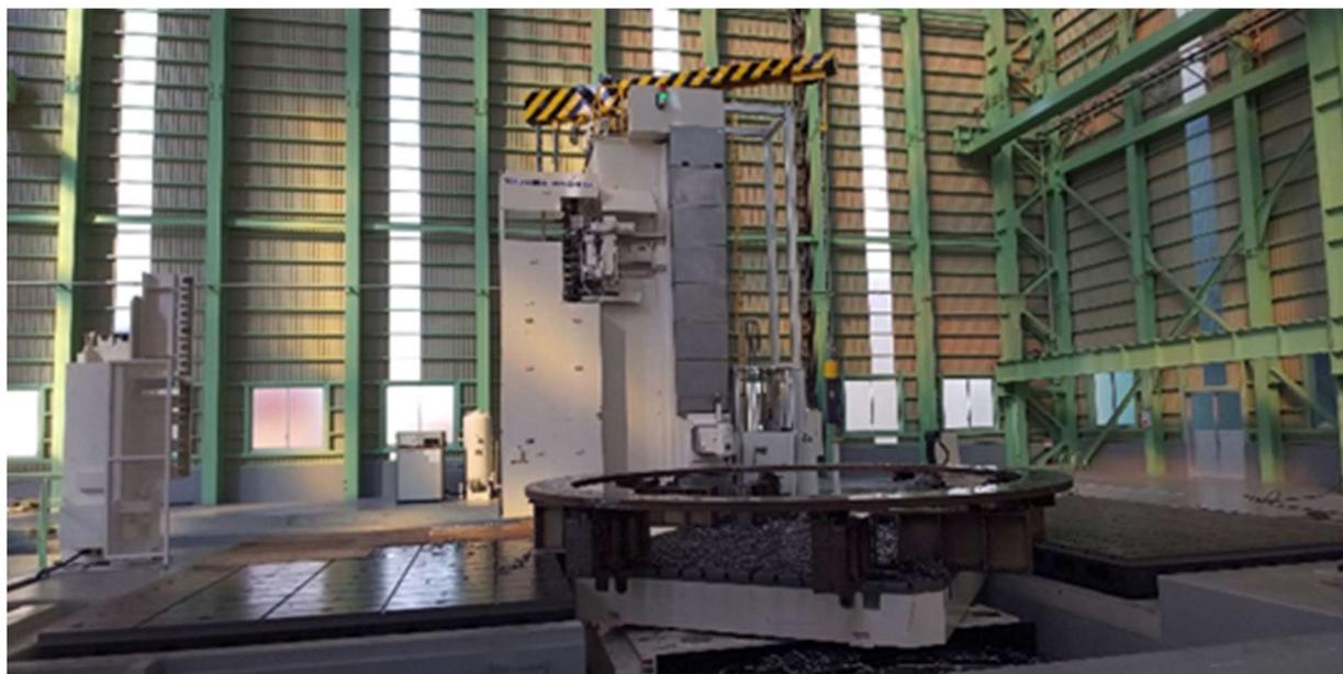
図 38. φ6,000mm の素材を加工
