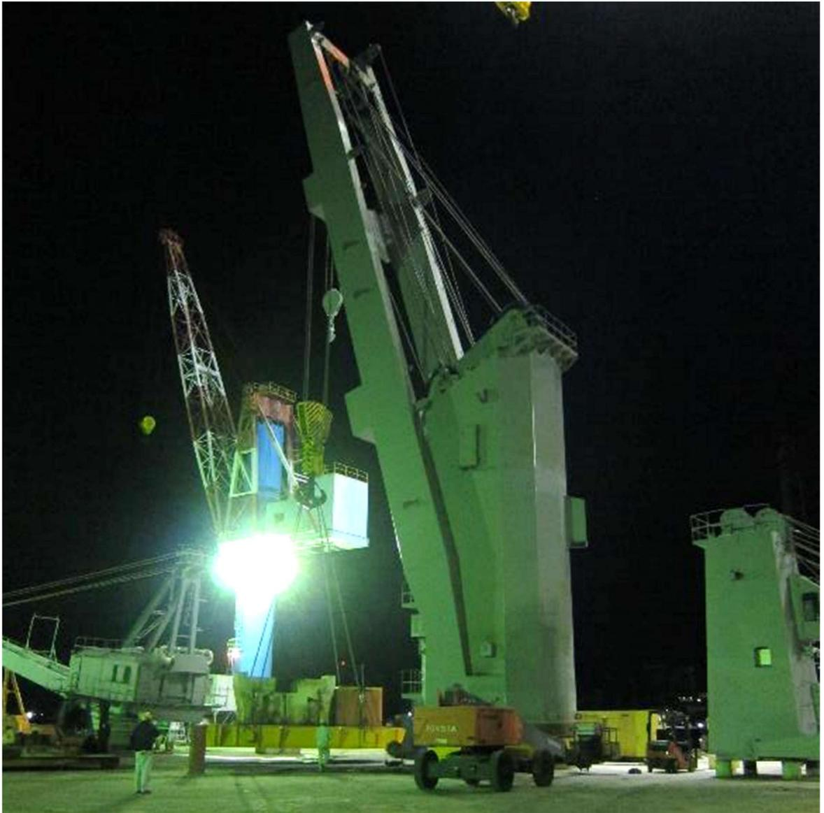
図 53. 荷重試験の様子 (150 トン)
