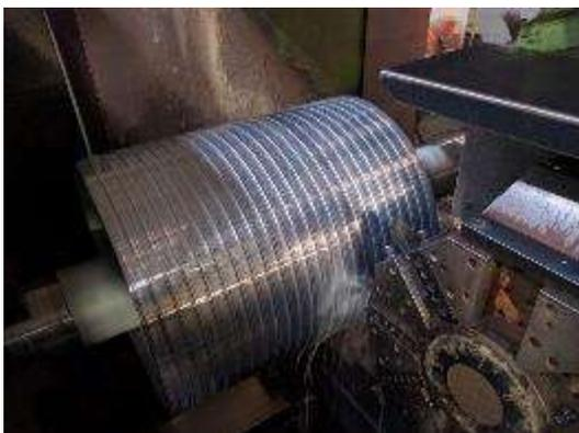
図 36. ドラム溝旋盤加工
