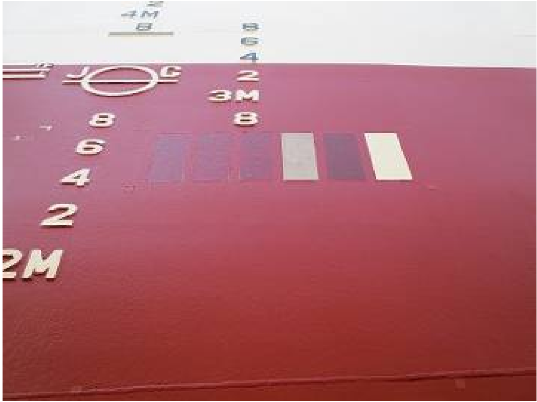
図 3 5 実証予備試験用塗料の乾燥 4 日後の状態（上部塗装箇所）
