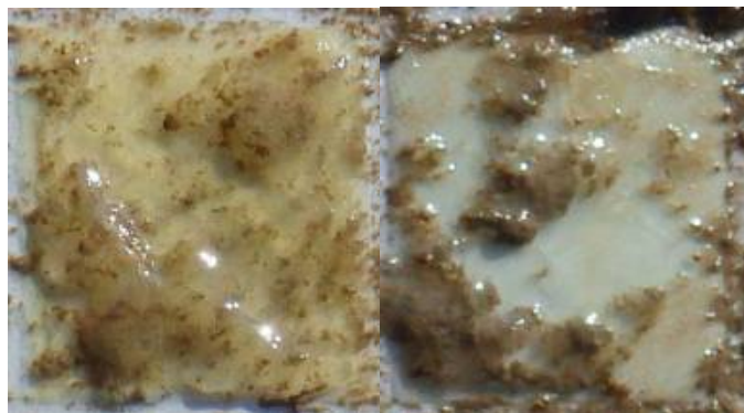
図13 水性樹脂 I (左) とアクリル樹脂 H (右) 塗膜上に形成したバイオゼリー
