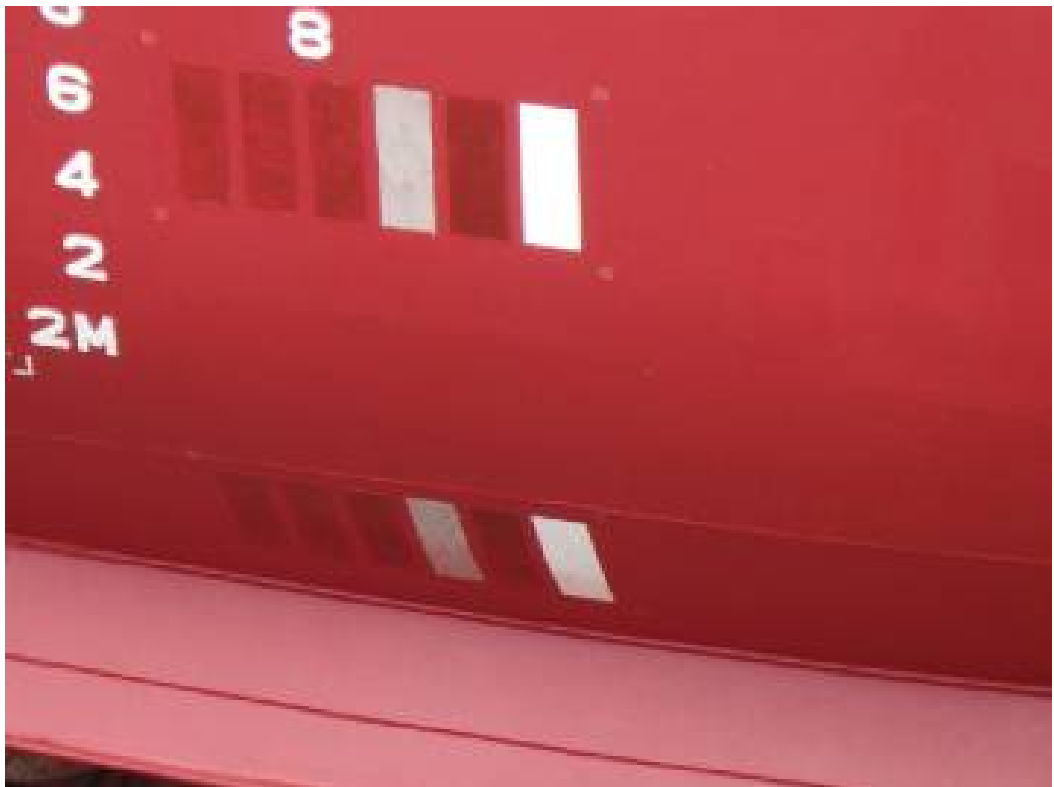
図 3 2 実証予備試験用塗料の塗装直後の状態
