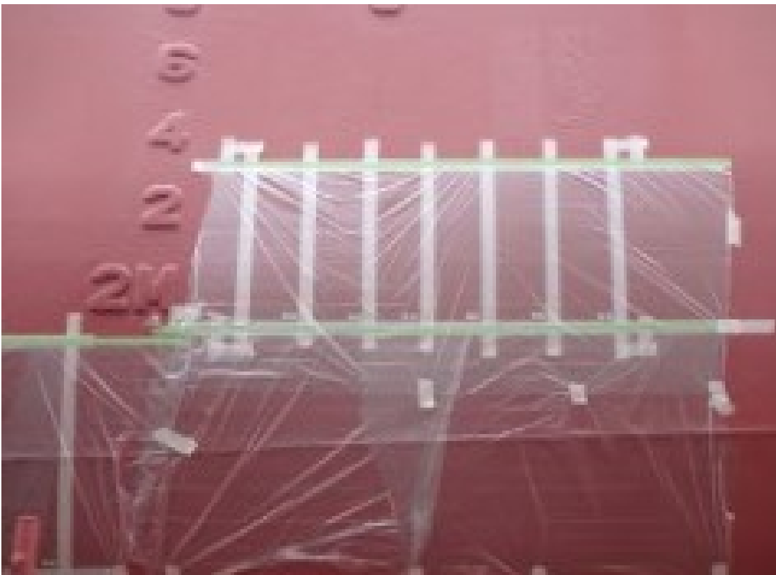
図 8 2 実証試験用塗料塗装準備（養生テープ貼り付け）
