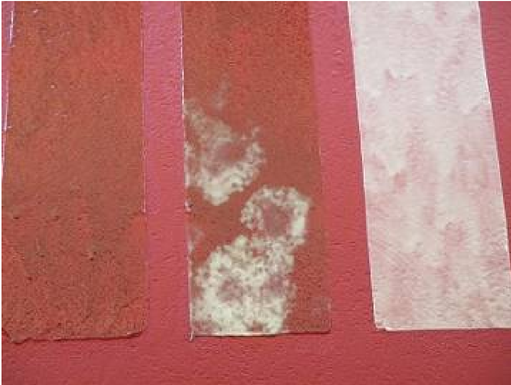
図 3 7 実証予備試験用塗料の乾燥 4 日後の状態（下部 No. 3 塗膜）
