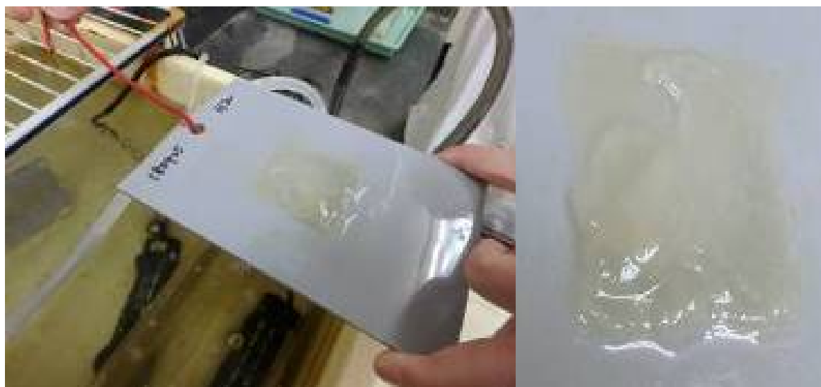
図21 バイオゼリー形成能評価試験装置に浸せきした塗膜の上に形成したバイオゼリー
