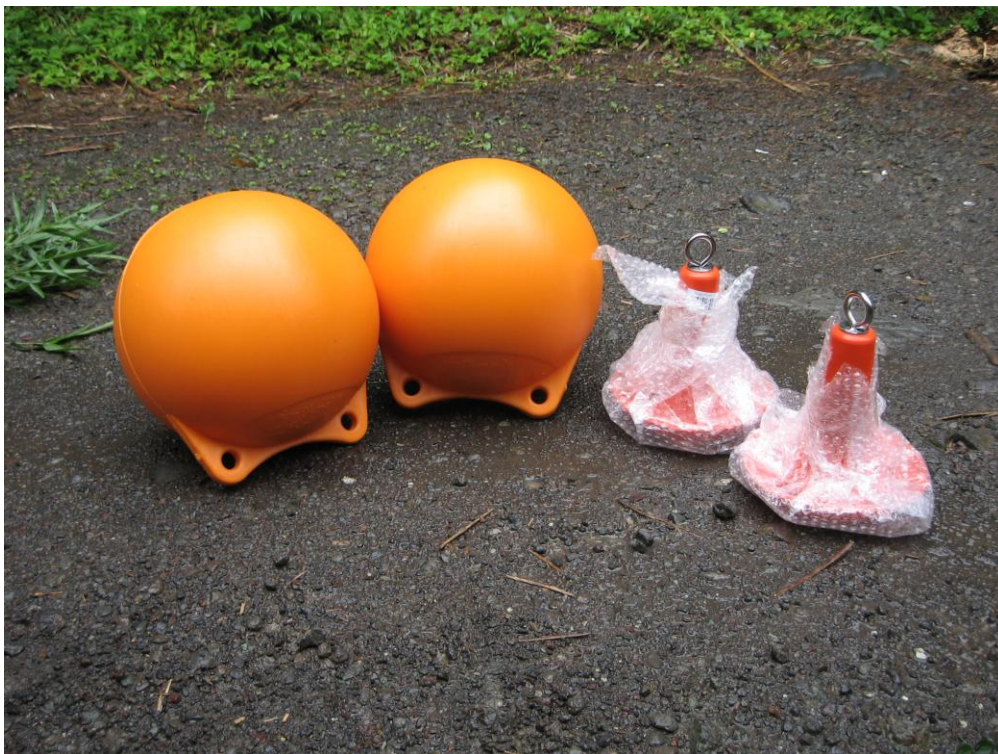
マッシュルーム型アンカー 3Kg(右、一部) 及び フイ (30cm オレンジ、左)
