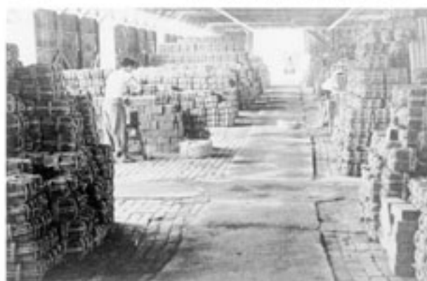
窯出しされたれんがの梱包作業
