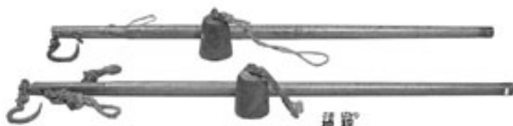
いろいろな手鉤類 おもに穀物の入った袋物の荷役作業に使用。 現在も漁業・荷役などで一部使用されています。
