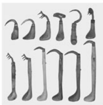
いろいろな手鉤類 おもに穀物の入った袋物の荷役作業に使用。 現在も漁業・荷役などで一部使用されています。
