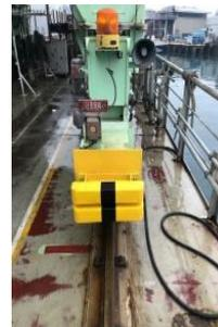
緊急停止用バンパースイッチ導入の例
