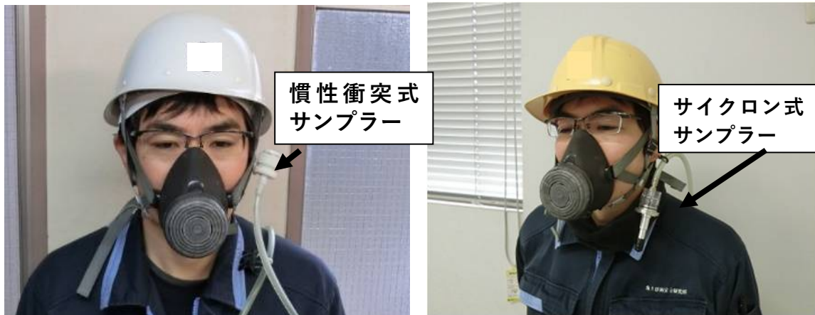
図 10 不適切な測定機材（採取口）の装着例（採取口が溶接用の面体の内側に位置できない）
