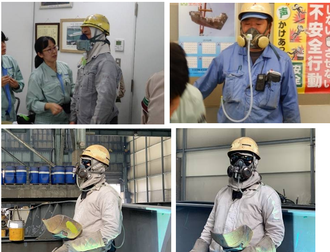
図9 適切な測定機材(採取口)の装着例(上段:慣性衝突式、下段:サイクロン式) (上段の写真は、(一社)日本造船工業会提供)
