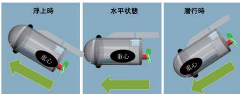
図 1 : 上下方向への移動方法 (中心図がデフォルトの状態。浮上時は重心が後ろへ動き左図のような姿勢になる。右図は潜行時で、重心は前に来る。)
