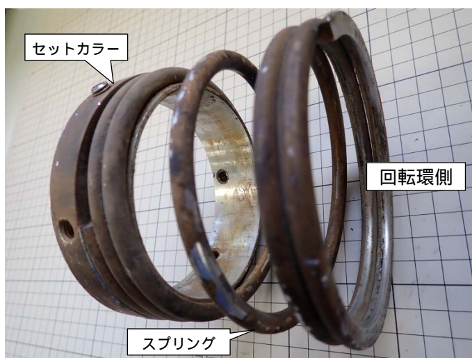
図 4.1.3 交換前メカニカルシール
