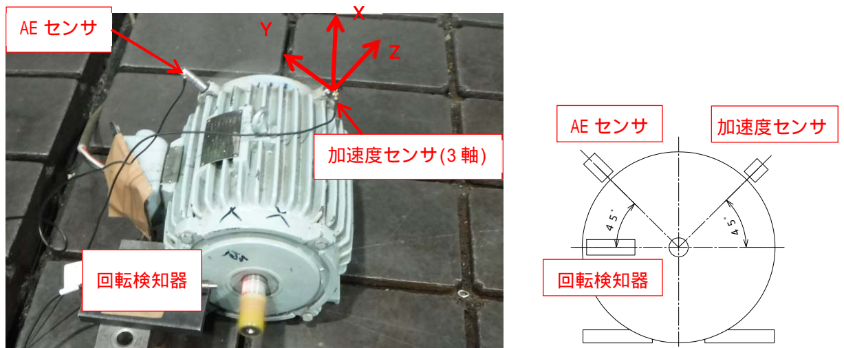
図 4.1.56 試験モータとセンサ位置
