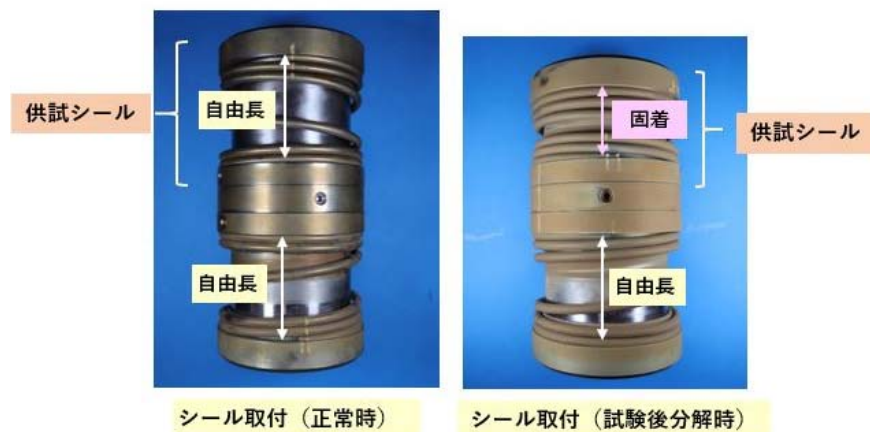
図 4.4.16 スリーブ (治具) 上への回転環取り付け状態
