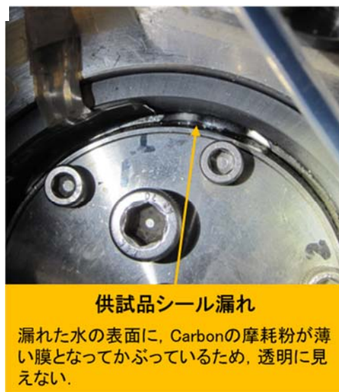
図 4.4.11 静圧試験漏れ及び計測方法
