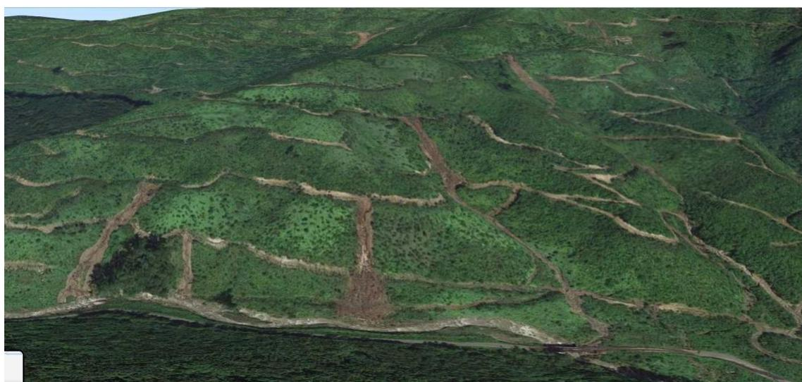
(大規模に皆伐された現場で作業道起因の崩壊が至る所で発生：2016 年岩泉)
