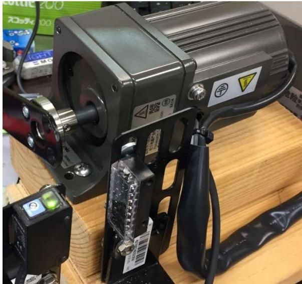
写真-6 主機関回転を模擬テスト用として手動回転制御可能な様に製作
