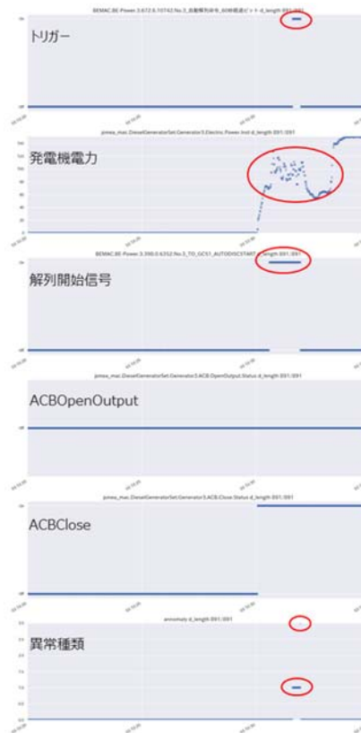
図 49 自動解列不良解析機能のトラブルシューティング自動化機能に関する評価結果 (赤丸は異常を検知した箇所を示す)
