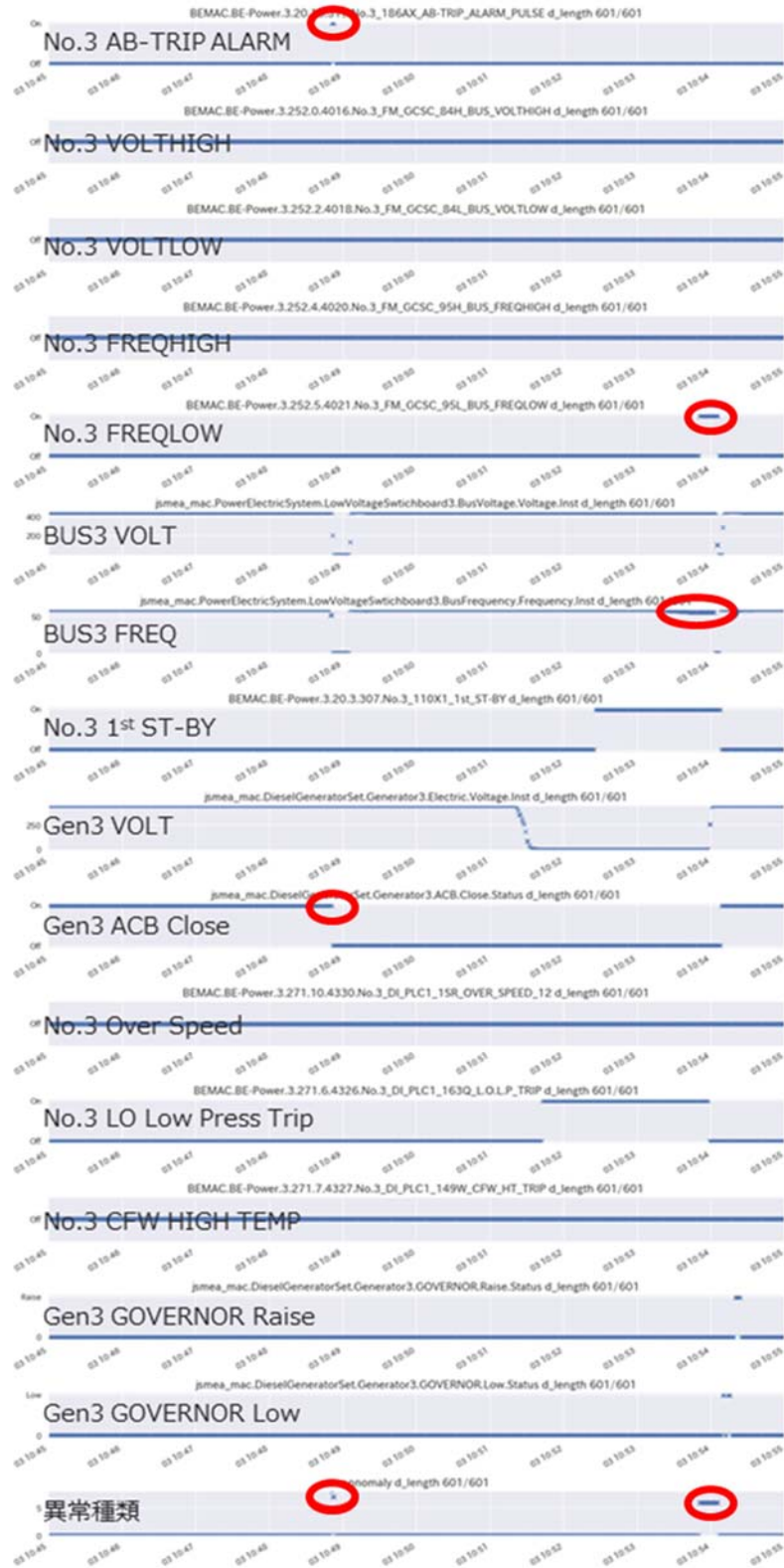
図 45 ブラックアウト解析機能のトラブルシューティング自動化機能に関する評価結果 (赤丸は異常を検知した箇所を示す)
