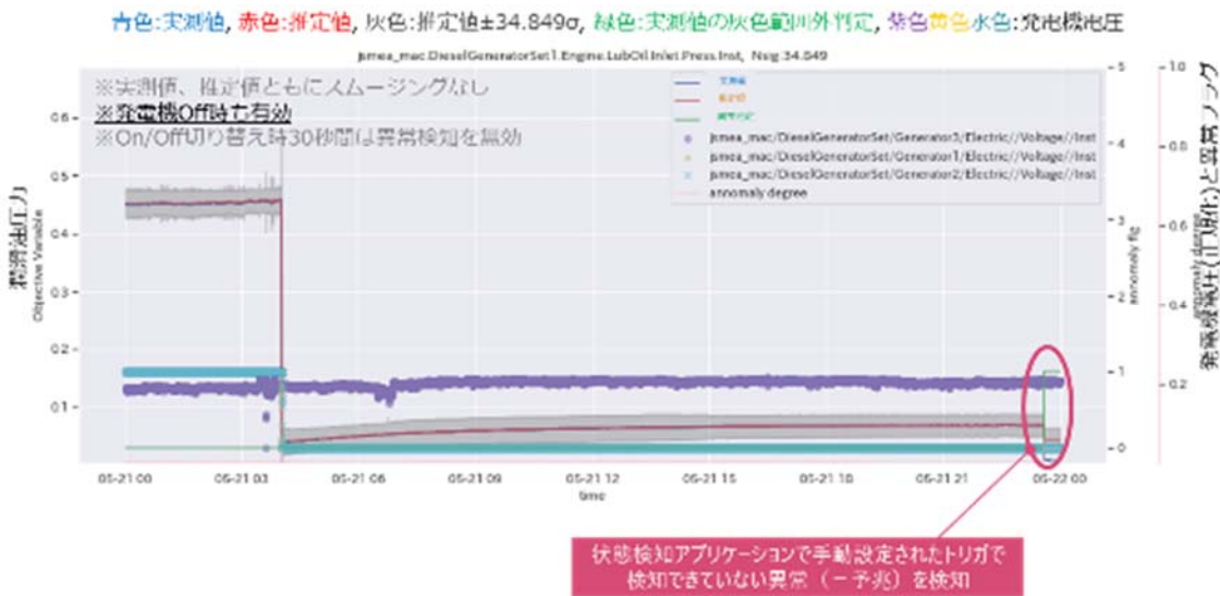
図 67 異常検知の一例 (対象船の2021年5月22日の#1_D/G_潤滑油入口圧力)
