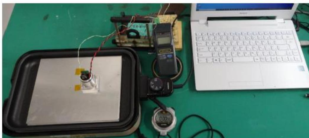
図 73 温度センサ応答評価試験
