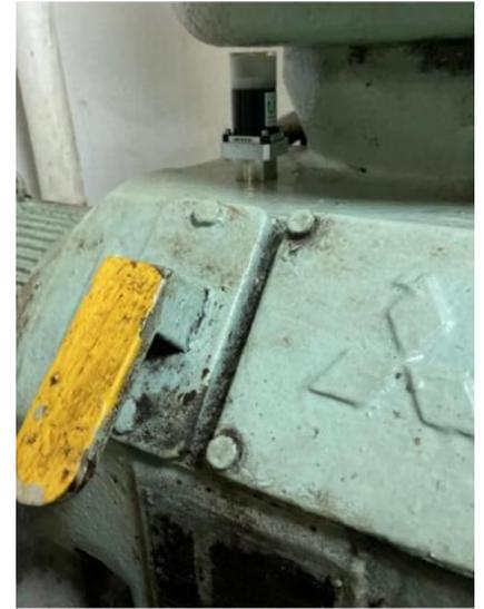
図 148 ③①No2 FOピューリファイヤー のセンサ設置場所
