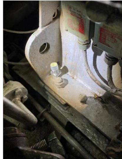
図 101 ⑱No2 補機 Eng ポンプ側 (前/左舷) のセンサ設置場所
