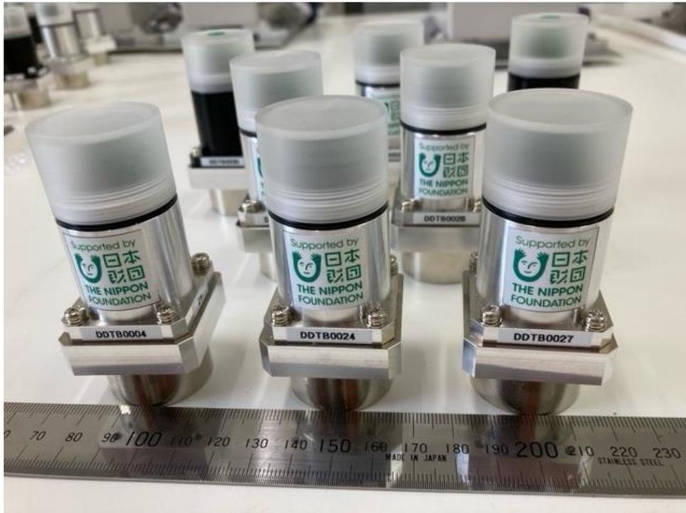
図 67 IoT 無線振動・温度センサの外観
