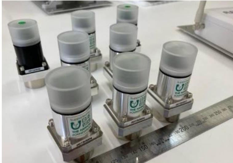
図 89 IoT 無線振動・温度センサ
