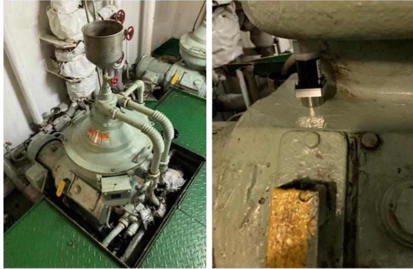
図 145 ②9No1 FOピューリファイヤー のセンサ設置場所
