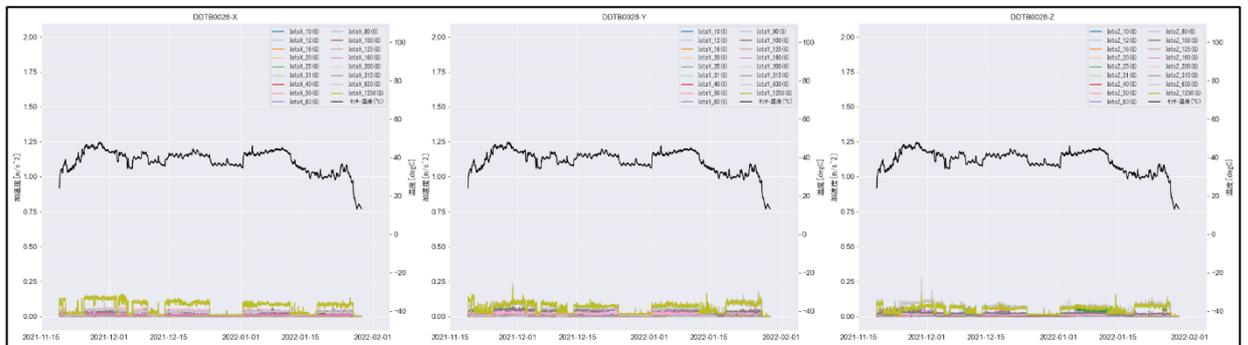
図 129 ②8FO 輸送ポンプ ポンプ側 設置センサの振動データ (X, Y, Z 軸)
