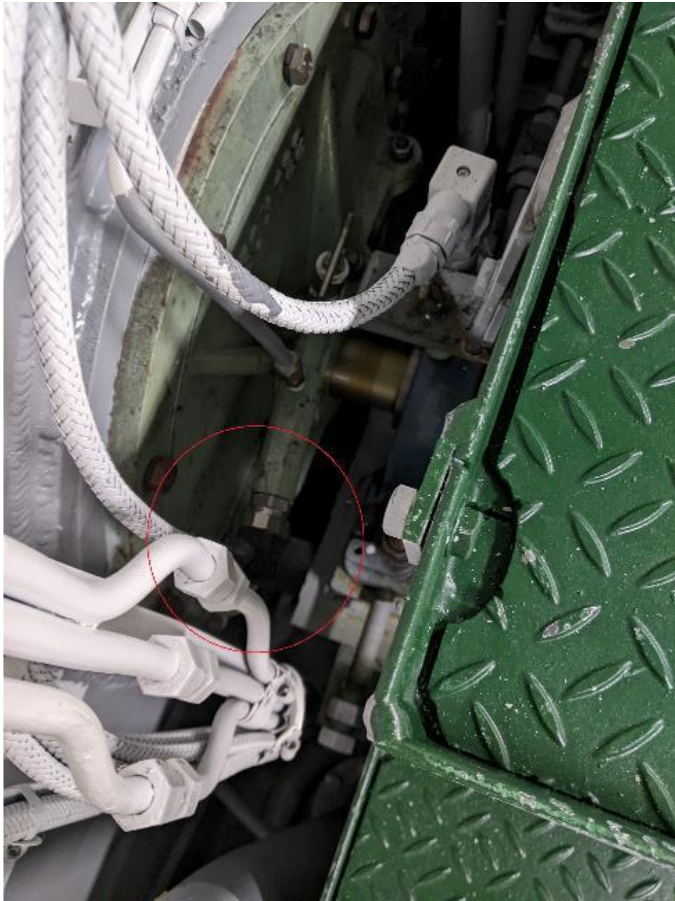
写真3 スタフィングボックスへ取付けた温度センサーとデジタル信号出力回路
