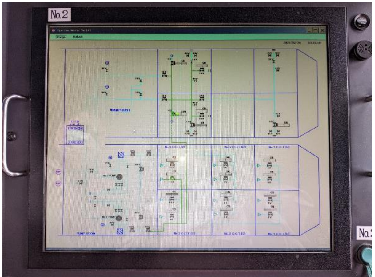
写真 23 事前計画した色付き荷役ラインと色付き使用バルブ
