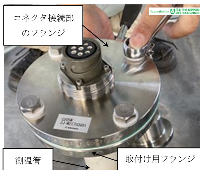
図 89. 導通確認のための抵抗値測定部分
