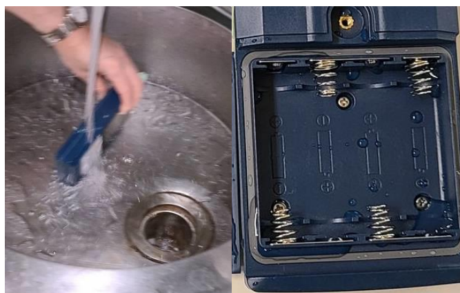
図 51. 水道による防滴性の予備試験風景
