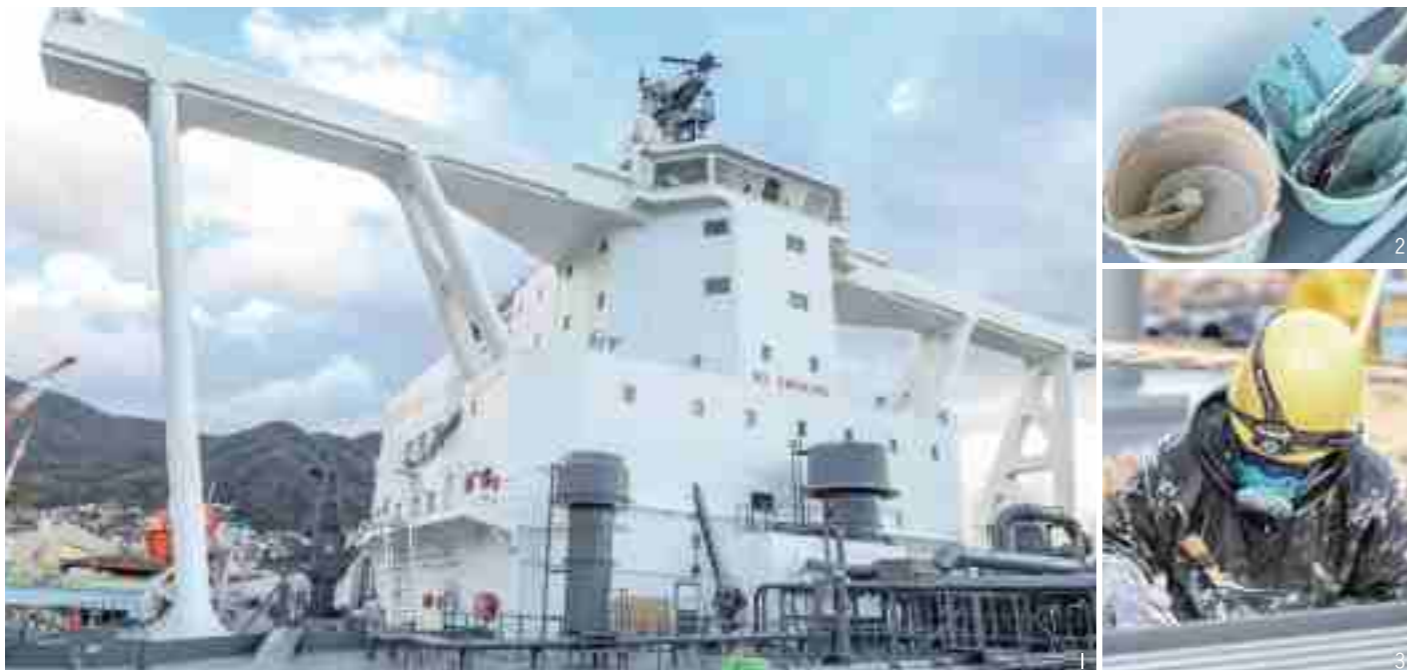
1.撮影日は、引き渡し2日前という絶好のタイミング。白を基調にきれいに彩られた船は、これから世界の海を駆け巡る 2,3.塗装する場所やパーツ、用途によって使用する塗料は異なる。何十種類もの塗料を使いこなし、手先を器用に動かしていく。頭も使う職人技だ
