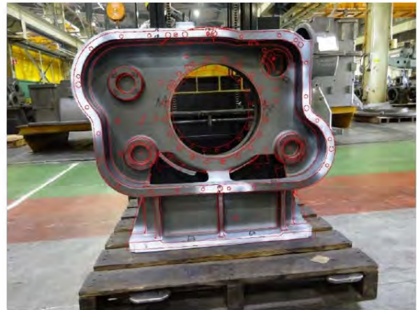
アプリケーションにより抽出した図面形状と実物との比較例
