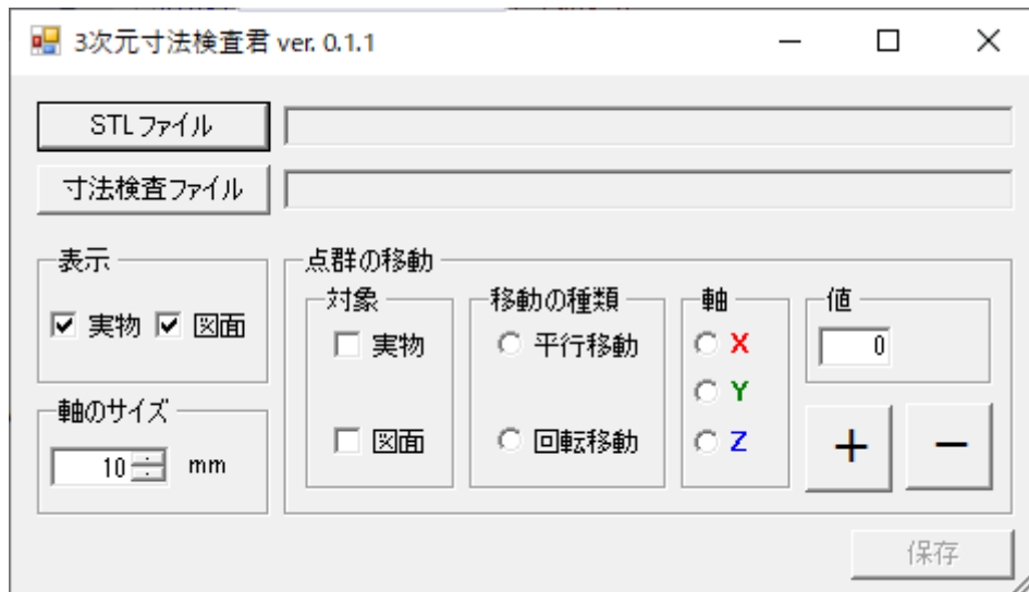
図 2.3-6 三次元スキャナを用いた実物の点群データとの比較アプリケーション外観
