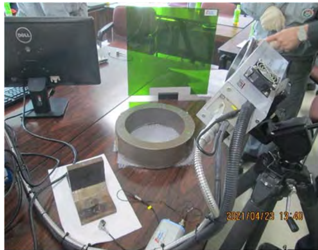
図 4.2-1 レーザー超音波可視化システムを使用した鋳造品内部欠陥検査デモ風景
