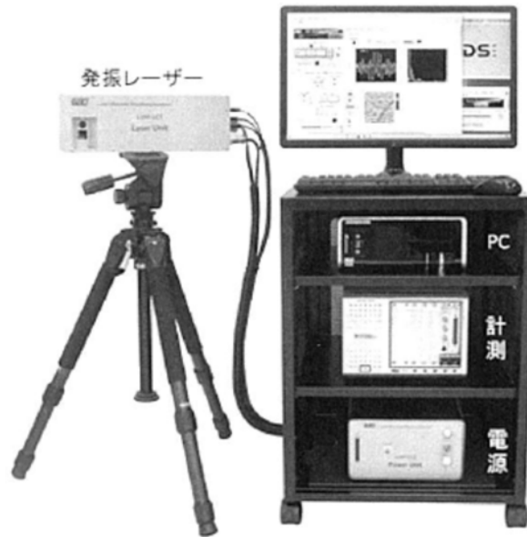
図 4.1-2 レーザー超音波可視化システム外観 8)
