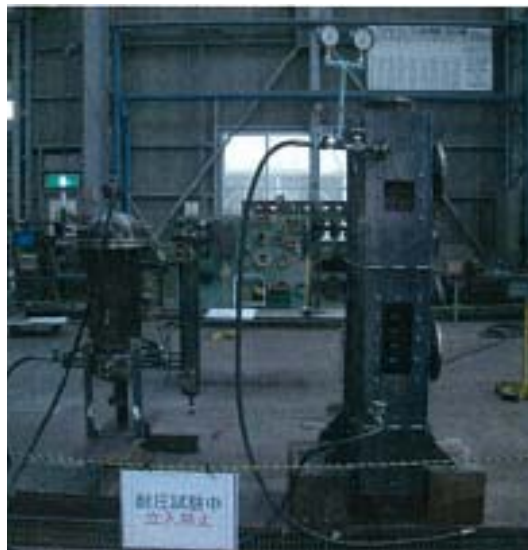
図9 サイレンサ A と汽水分離タンクの耐圧試験風景 右：サイレンサ A、左：汽水分離タンク
