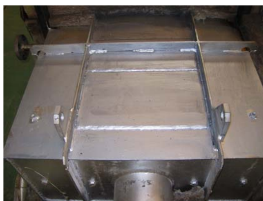
図 85 切り取った側壁の修復跡
