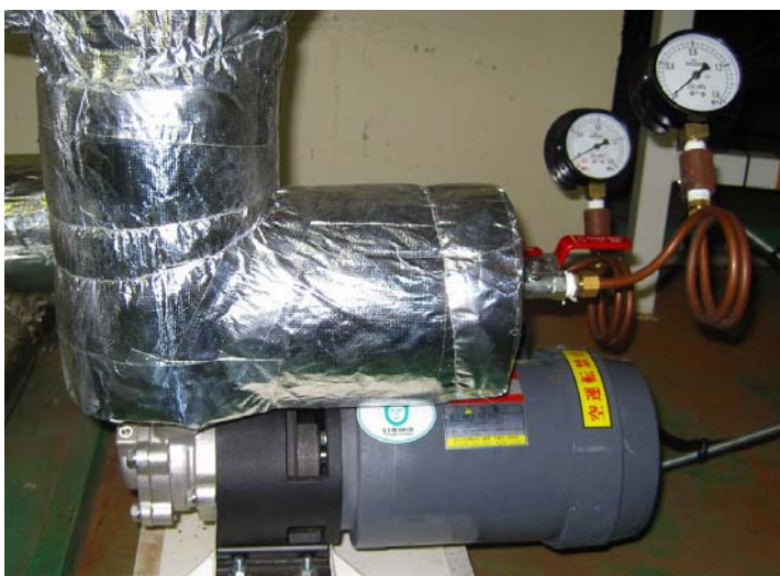
図 55 無冷却型循環水ポンプ（左）と同サイリスタ流量制御盤（右）
