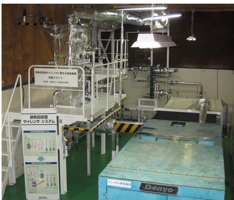
図 28 試運転を待つばかりの排熱回収型サイレンサ試験装置
