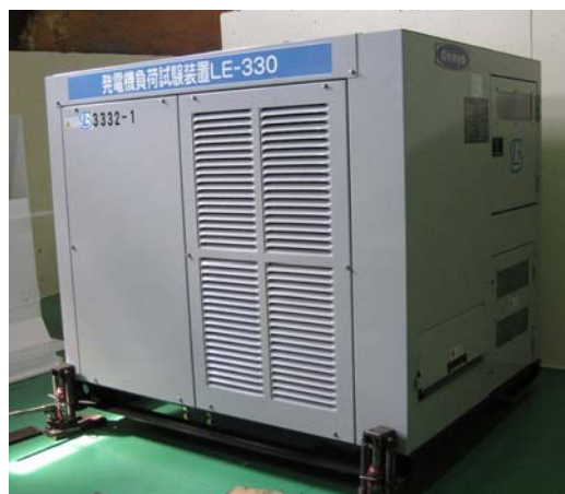
図4 電力をジュール熱として消費する連続負荷調整装置（レンタル機器）
