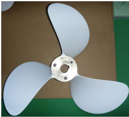
図 3.6.1.1 21PAC (プリプレグ+オートクレーブ成形、形状 : No. 1-5)
