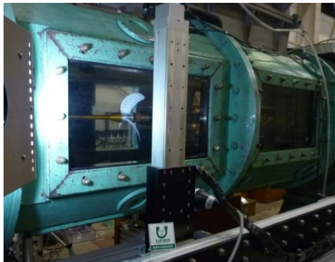
図 3.4.3.2 キャビテーション水槽計測部
