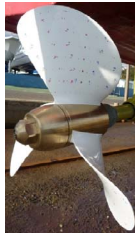
図 3.6.1.1 21PAC (プリプレグ+オートクレーブ成形、形状 : No. 1-5)
