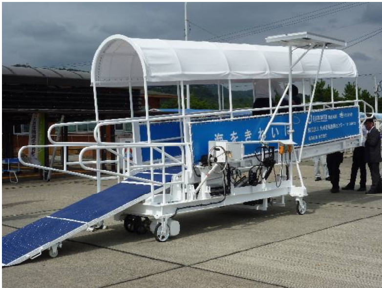
特殊シェルター（昇降用タラップ） 甌島商船(株)向け 1基 L 7800×W1500× H最低 850／最高 3550 mm
