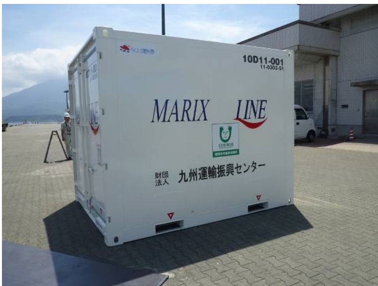
保冷コンテナ マリックスライン(株)向け 1 個 L 2991×W2438×H2438 mm
