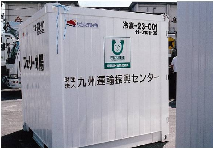
冷凍コンテナ 屋久島町向け 1 個 L2000×W2100×H2100 mm
