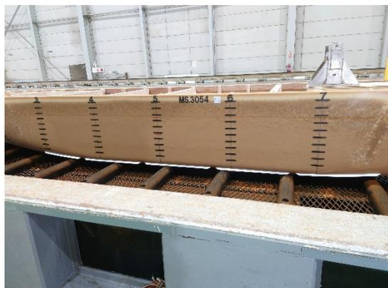
基幹船型の模型船（船側）
