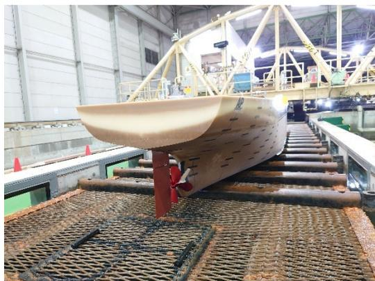
基幹船型の模型船（船尾）
