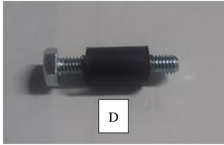
図 4 0 モックアップ試験用資材 (A : 止水用パッキン、B : 模擬陽極、C : 絶縁パッキン、D : 絶縁チューブ)
