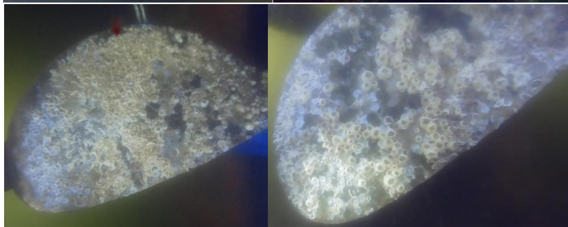
図 5 5 - 1 通電あり／なしのプロペラ表面の比較 (11 月～7 月)
