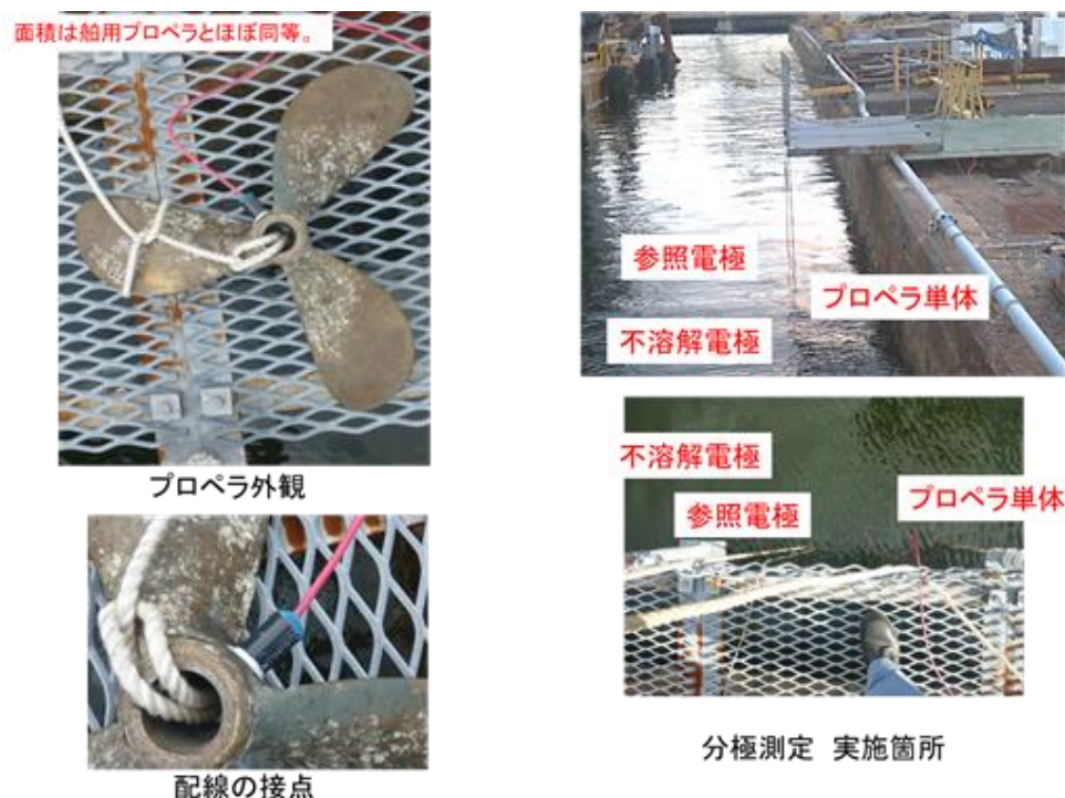
図 5 7 プロペラ単体の通電試験の様子
