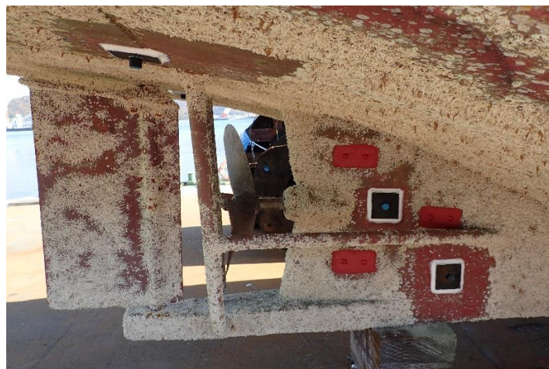
図46 通電用電極の配置
