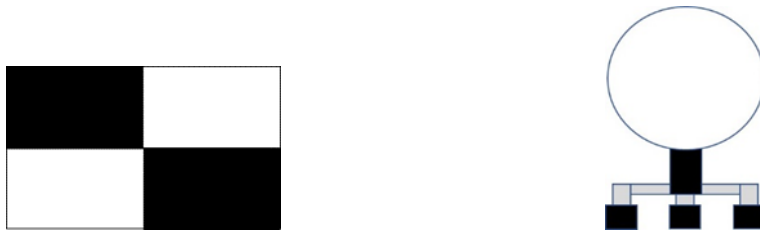
図 1 8 チェック状ターゲットおよび球状ターゲットの模式図
