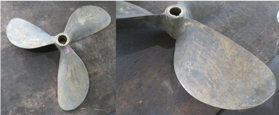
図50 研磨後のプロペラの様子（左：船首側、右：船尾側）
