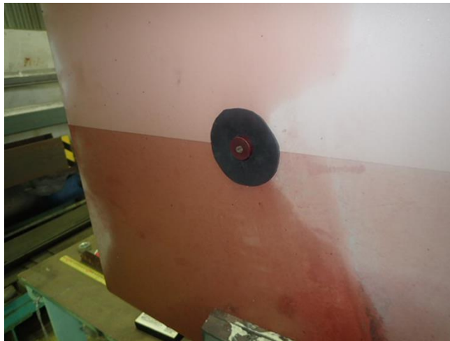
図 4 1 船内側の止水パッキン
