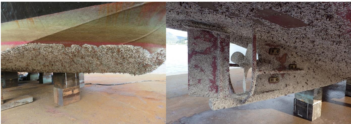
図45 小型船舶通電なし試験後の船体およびプロペラの様子（左：船首部、右：船尾部）
