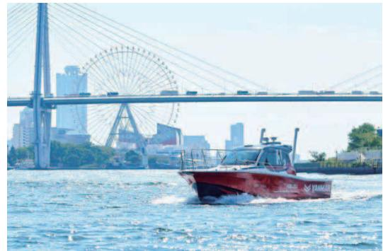
試験航行する水素燃料電池試験艇
