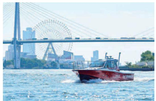
試験航行する水素燃料電池試験艇
