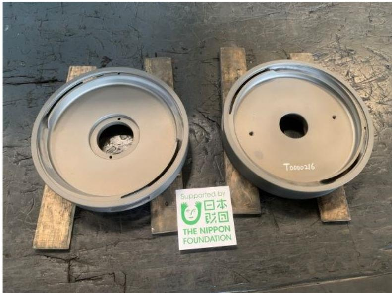
写真25. 2段ボリュート（左側）、1段ボリュート（右側）
