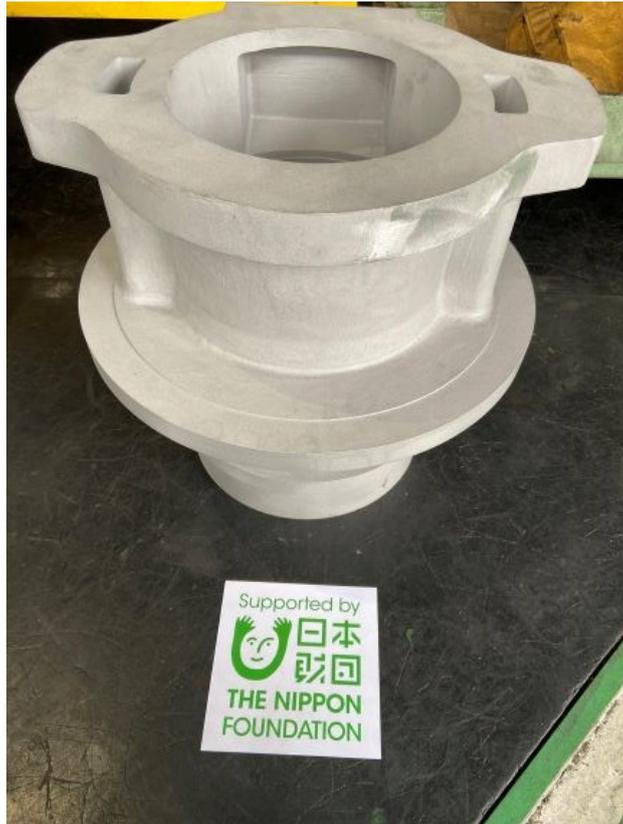
写真19. モータフレーム鋳物素材
