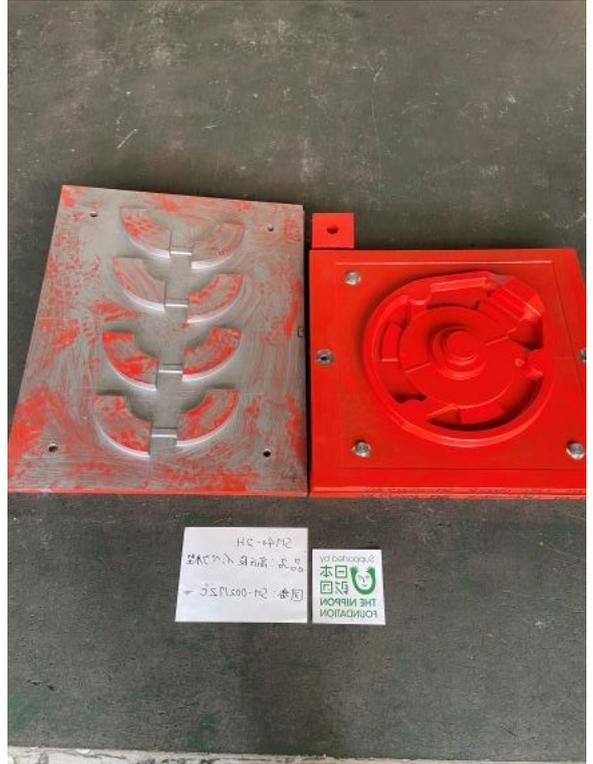
写真7. 1段インペラの木型 (左図：中子、右図：外型)
