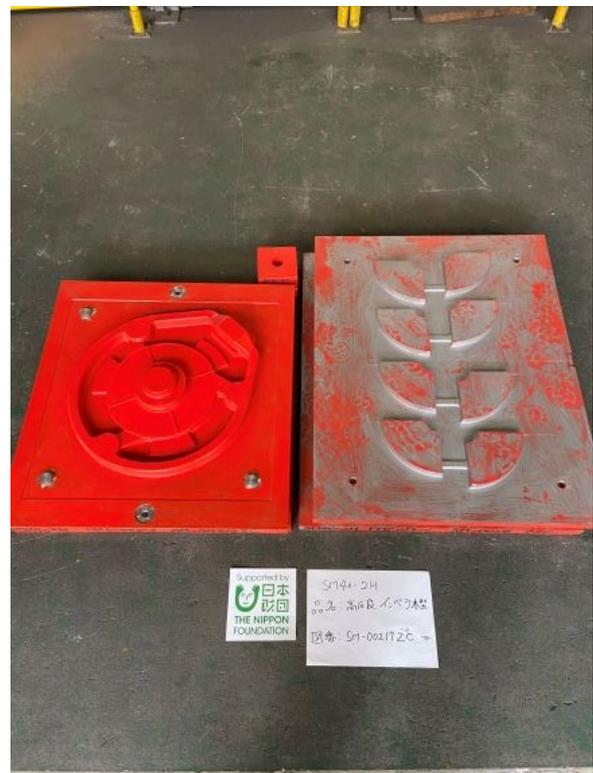
写真8. 2段インペラの木型 (左図：中子、右図：外型)
