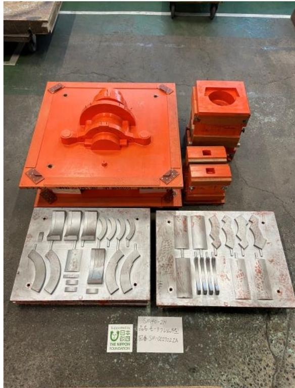
写真9. モータフレームの木型 (左図：外型、右図：全木型)
