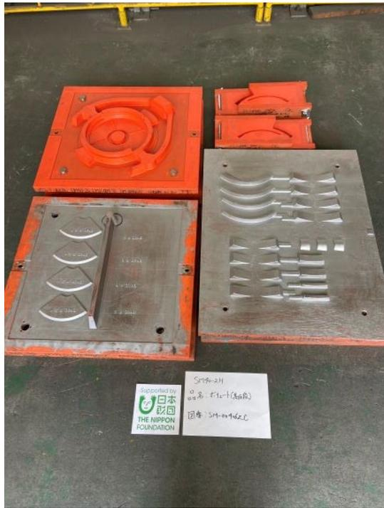
写真5. 1段ポリユートの木型(左: 1段ポリユート、右: 2段ポリユート)
