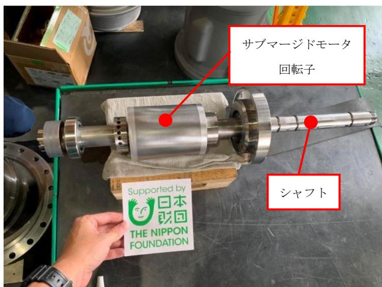
写真 2 2. サブマージドモータ回転子の組付け
