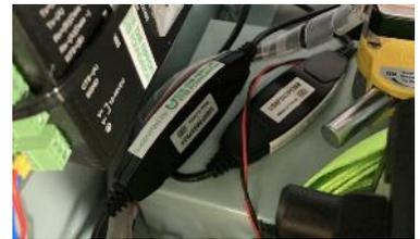
図 9-71 RS232C 変換器
