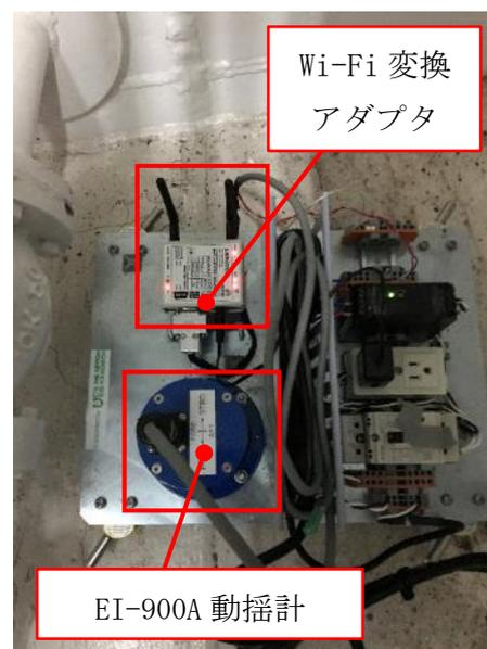
図 3-22 動揺計と Wi-Fi 変換アダプタ
