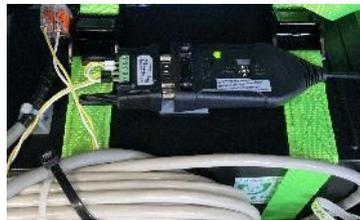
図 9-70 RS422 変換器
