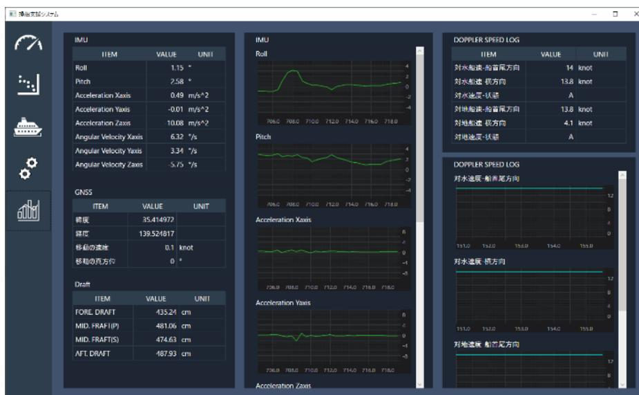
図 9-102 操船支援システム 計測画面
