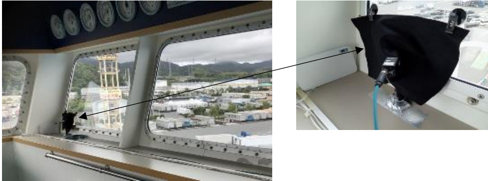
図 3 : ガラスの反射による映り込みの防止対策
