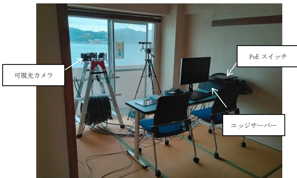
図 75：評価・実証 LAB に設置した試験機材
