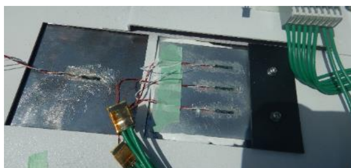
図-41 ダミーゲージ貼り付け状態
