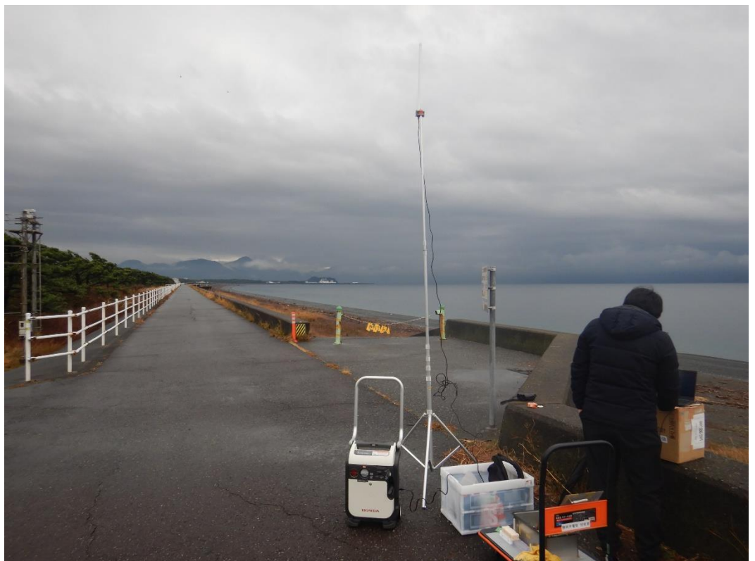
図-28 無線通信試験方法
