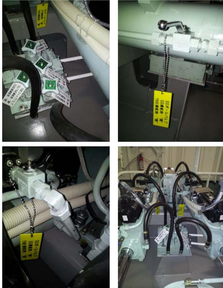
図 13.3 操舵切替用バルブブロック (各部写真)
