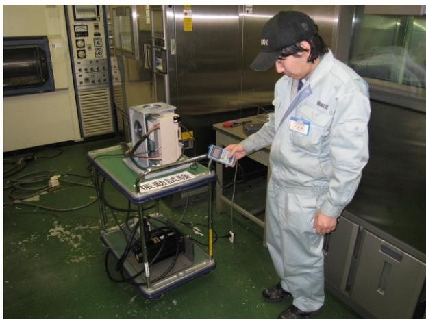
全試験後(前後方向耐久試験)後作動試験
