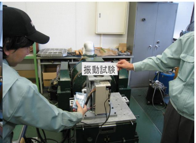
全試験(上下方向耐久試験)前 作動試験
