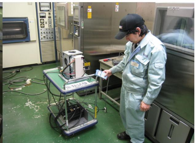
センサー（振動ピックアップ）取り付け位置 （試験品：SGDV-170D01A）
