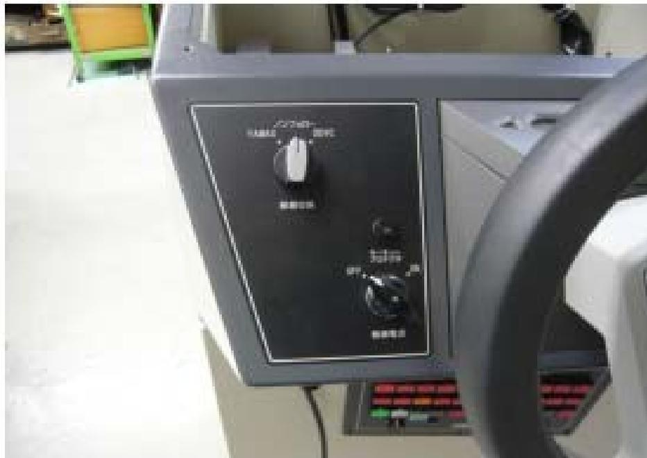
図 6.4 舵取機切替装置
