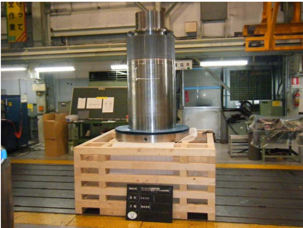
写真 6 2 出力軸の組立用木枠への設置
