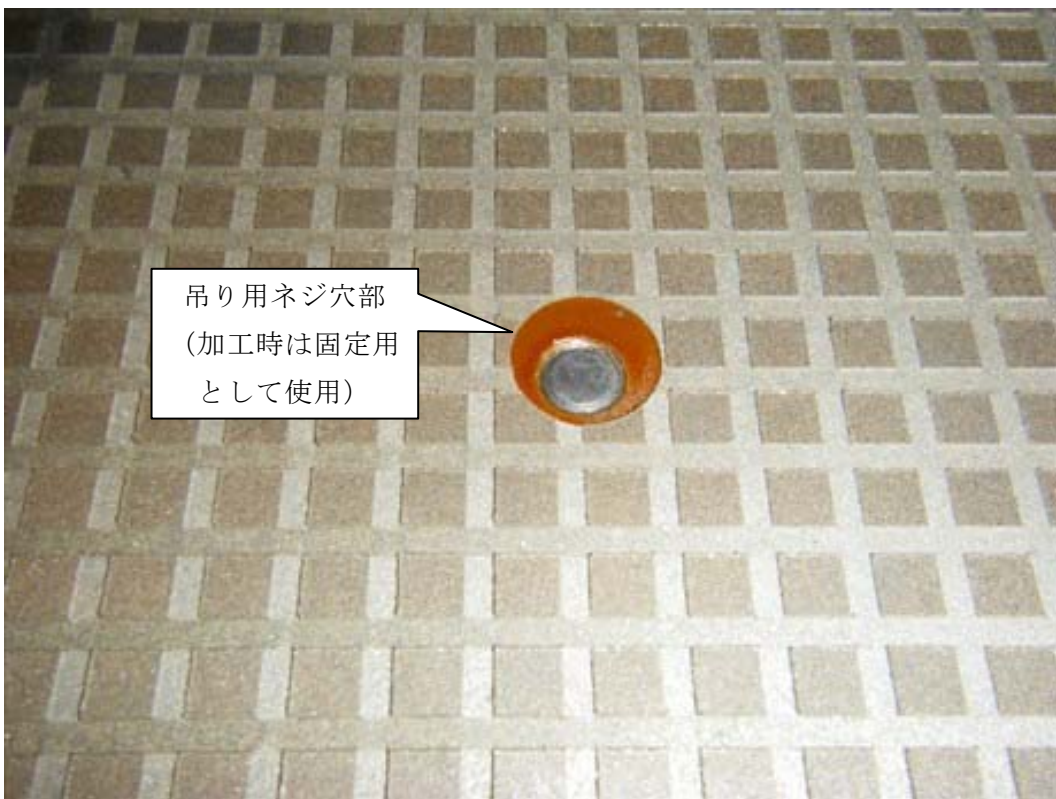
写真 3 5 溝加工後（吊り用ネジ穴部）
