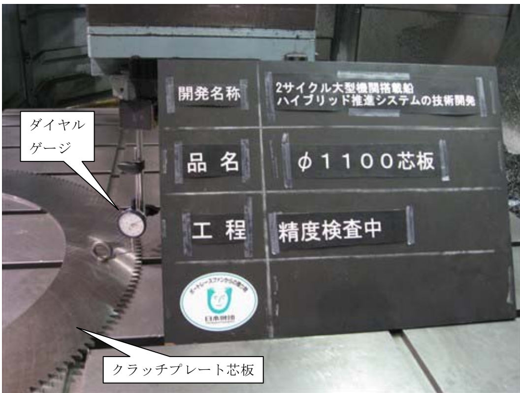
写真21 φ1100芯板精度測定中
