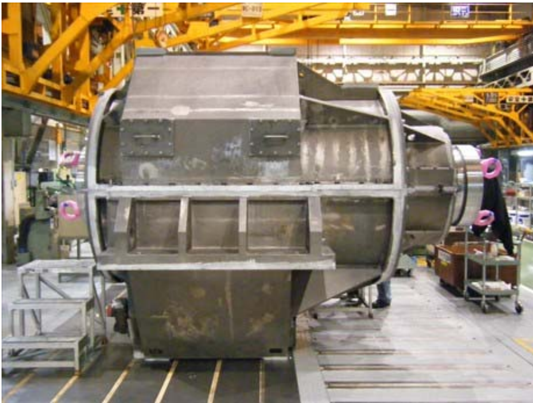
写真 8 1 上ケーシング (HSG-1) 組立完了
