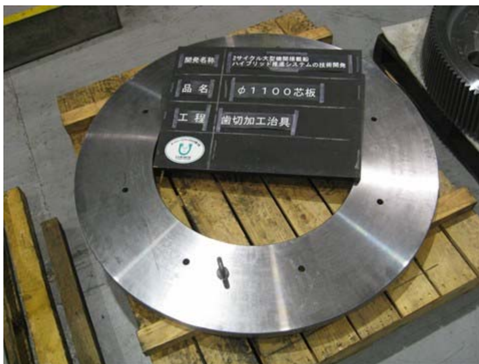
写真17 \phi 1100 芯板歯切り加工用治具（上側）
