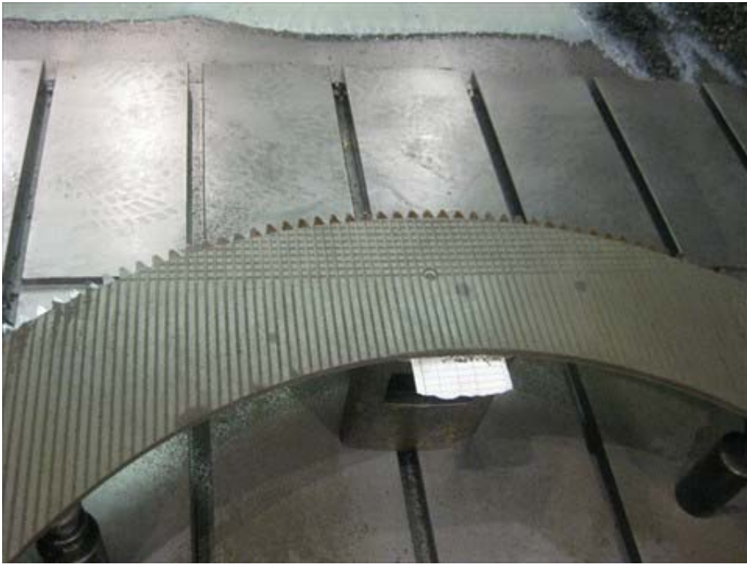
写真 3 0 摩擦面への溝加工中（交差溝）
