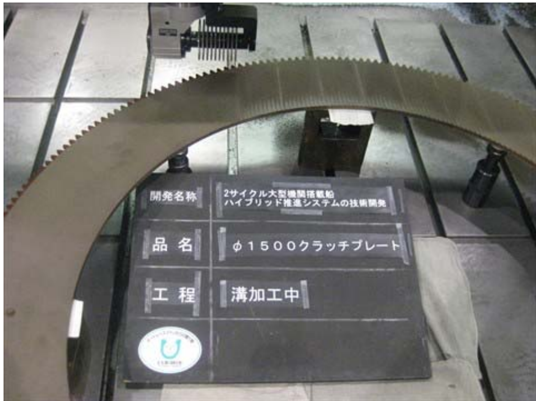
写真 2 8 摩擦面への溝加工中
