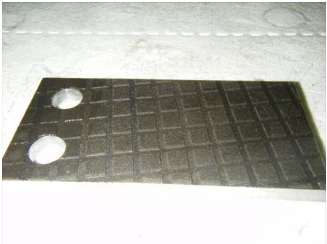
写真47 供試体（200%設計面圧付与後）
