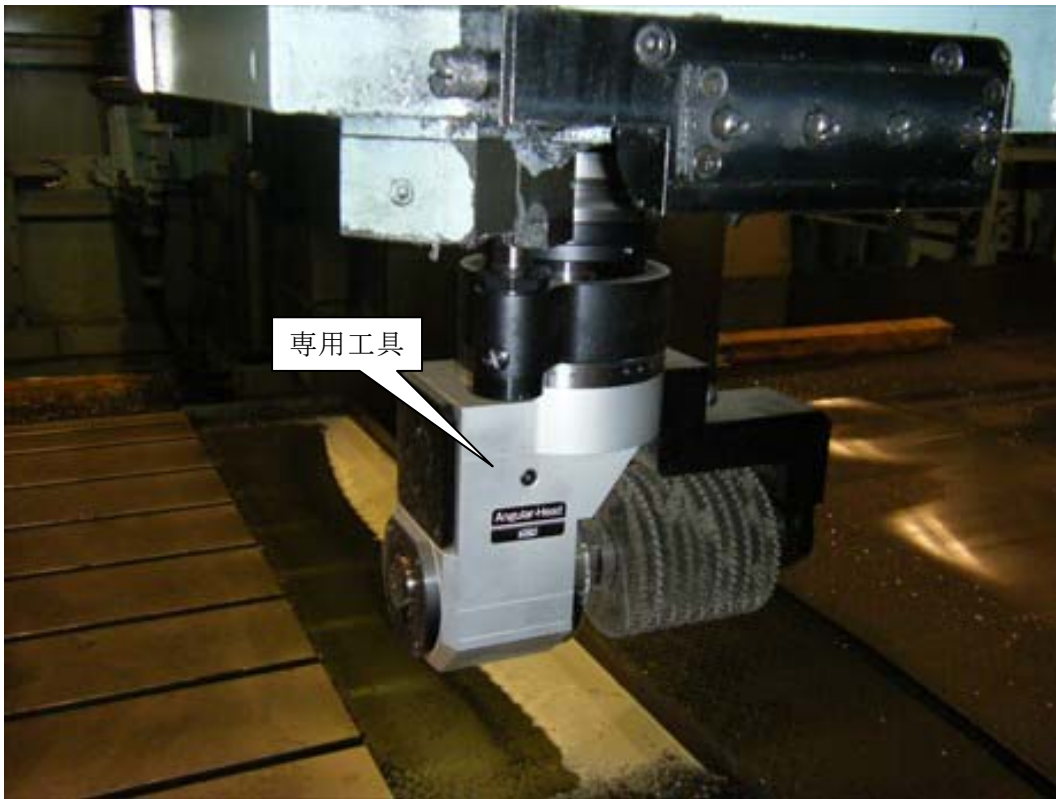
写真 2 6 専用工具を加工機械へ取り付けた姿
