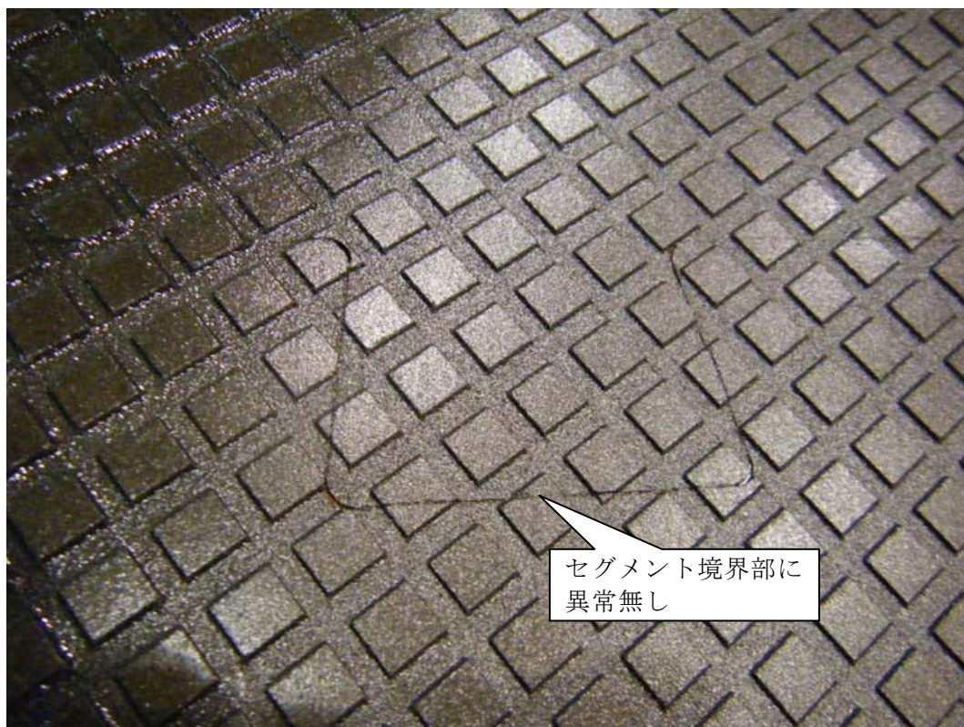
写真 9 3 負荷運転後のクラッチプレート接着面①
