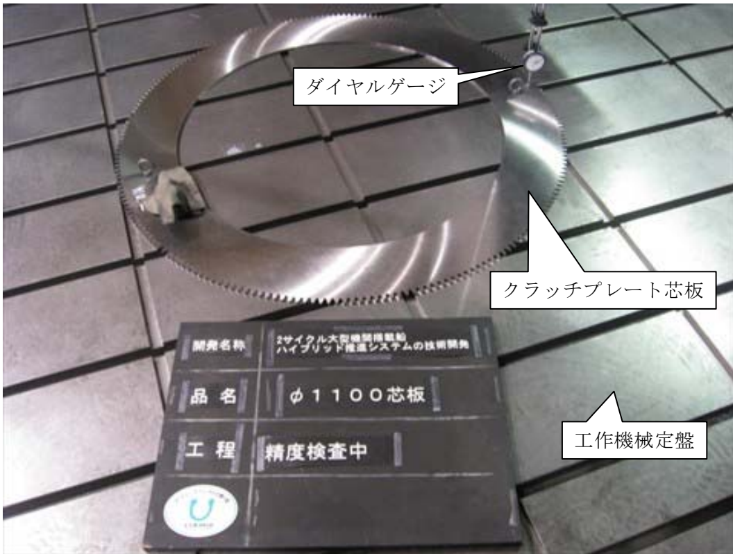
写真20 φ1100芯板精度測定中
