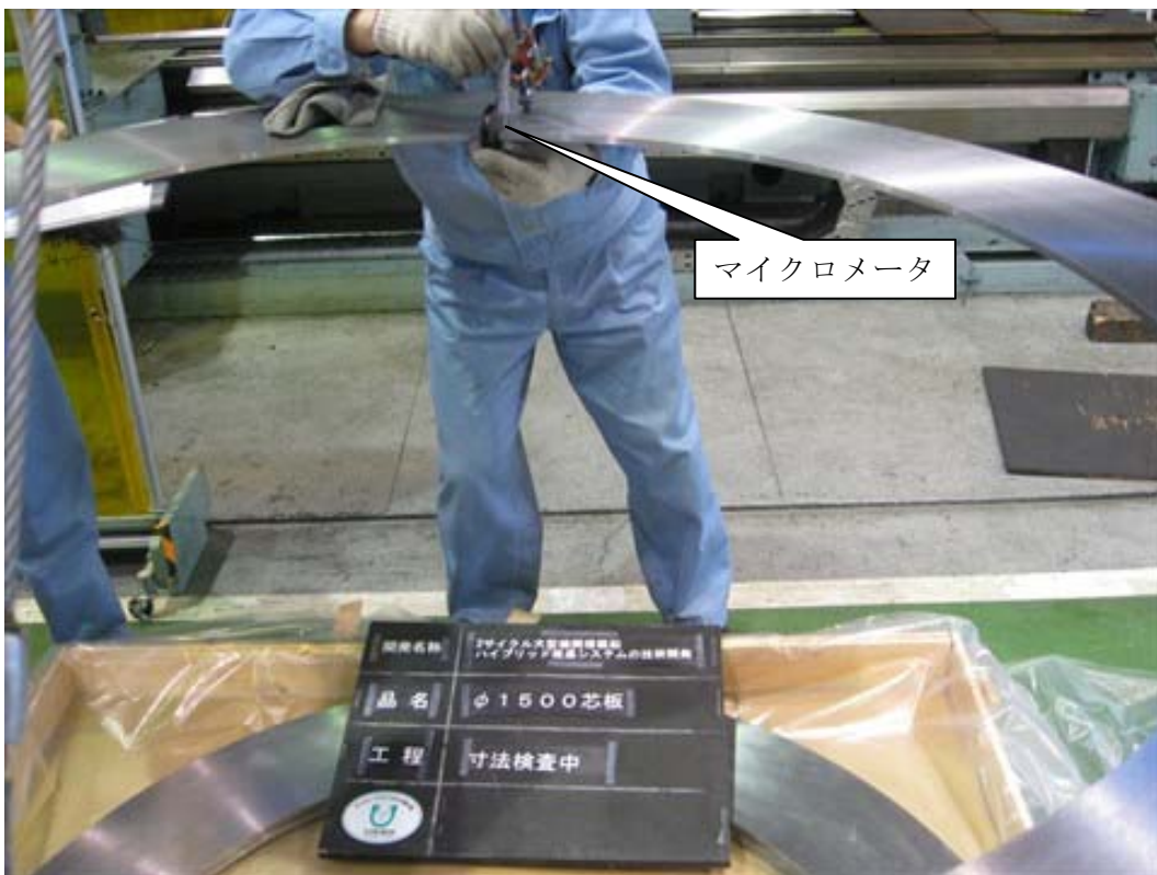
写真7 \phi 1500 芯板の厚さ寸法測定中
