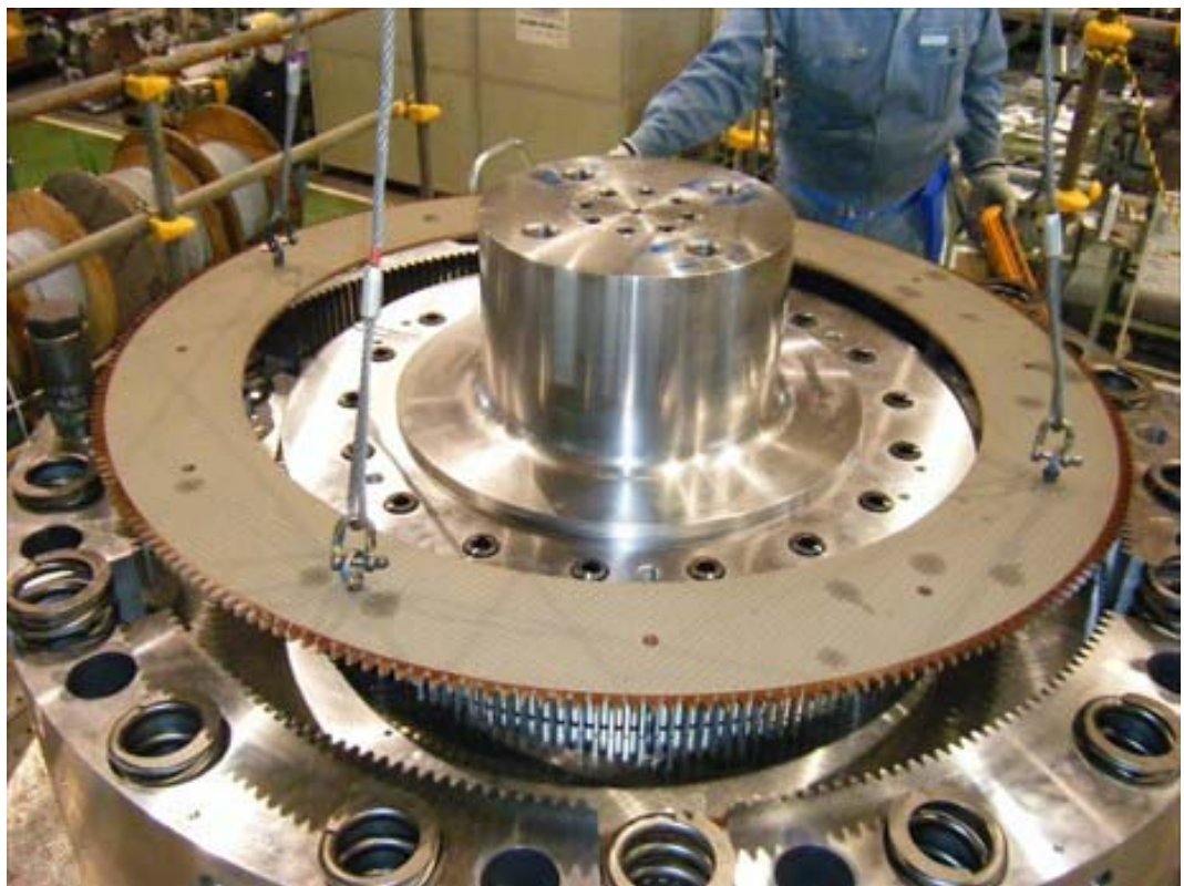
写真 6 8 クラッチプレート（マサツプレート）組み込み
