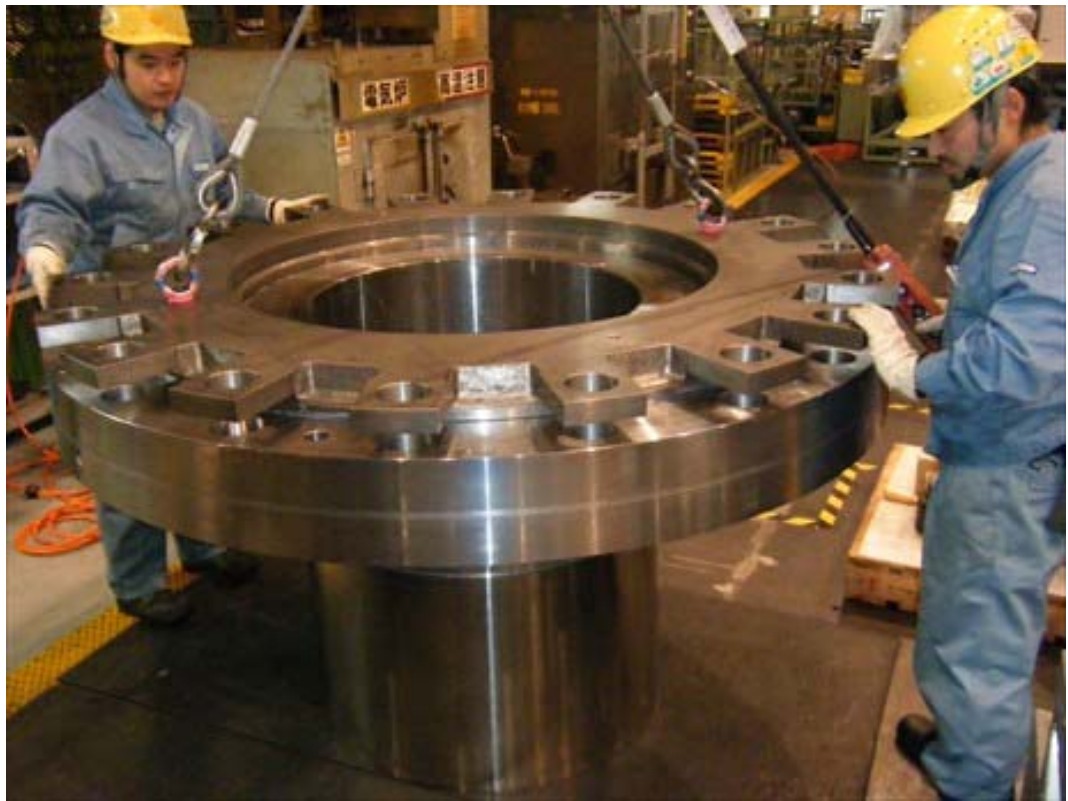
写真6 3 クラッチキャリアへのクラッチピストンを組み込み
