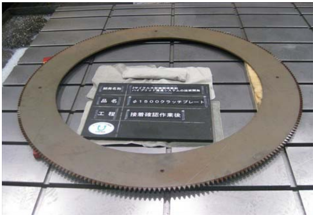
写真22 φ1500接着状態確認後（全景）
