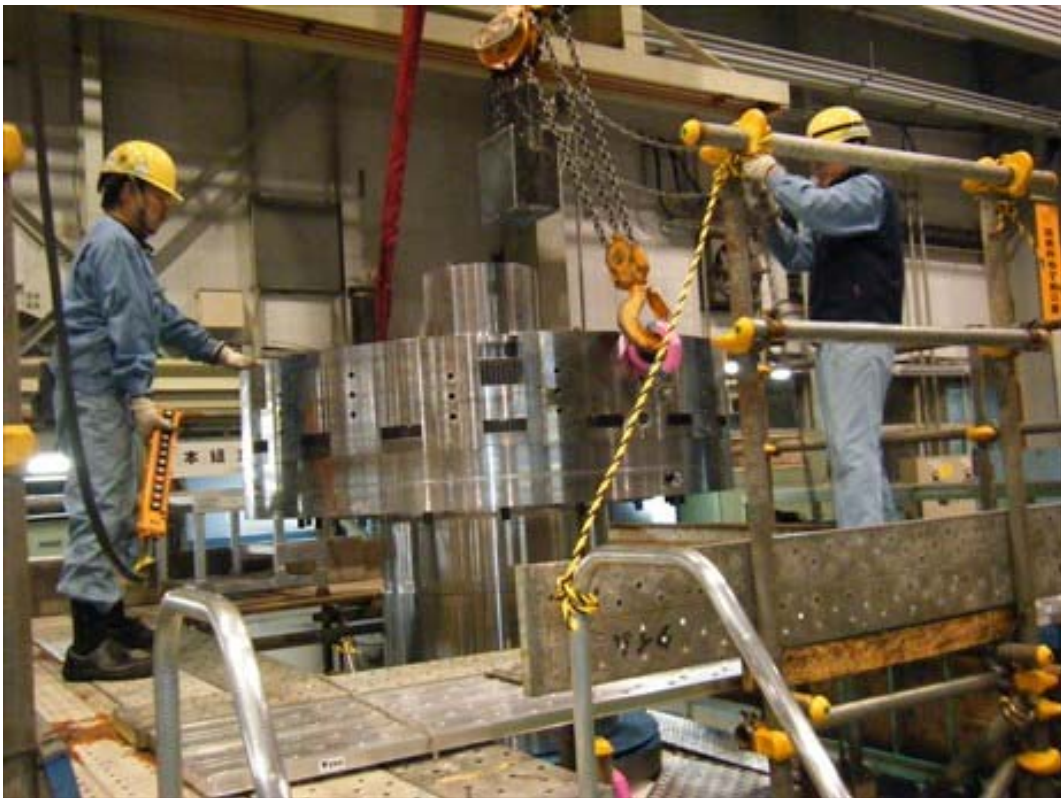
写真66 クラッチキャリア～クラッチリングを出力軸へ組み込み②
