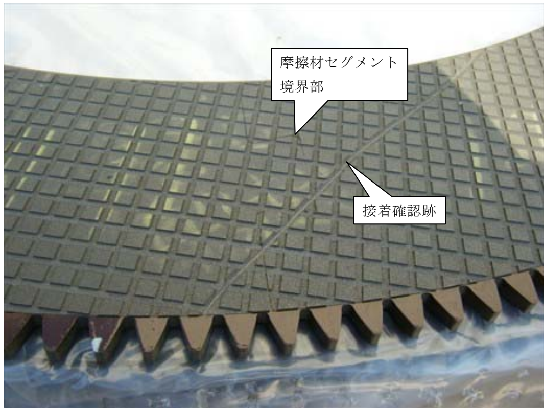
写真25 φ1100 接着状態確認後（境界部詳細）
