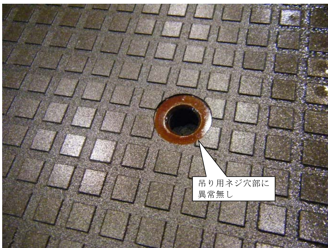
写真 9 4 負荷運転後のクラッチプレート接着面②
