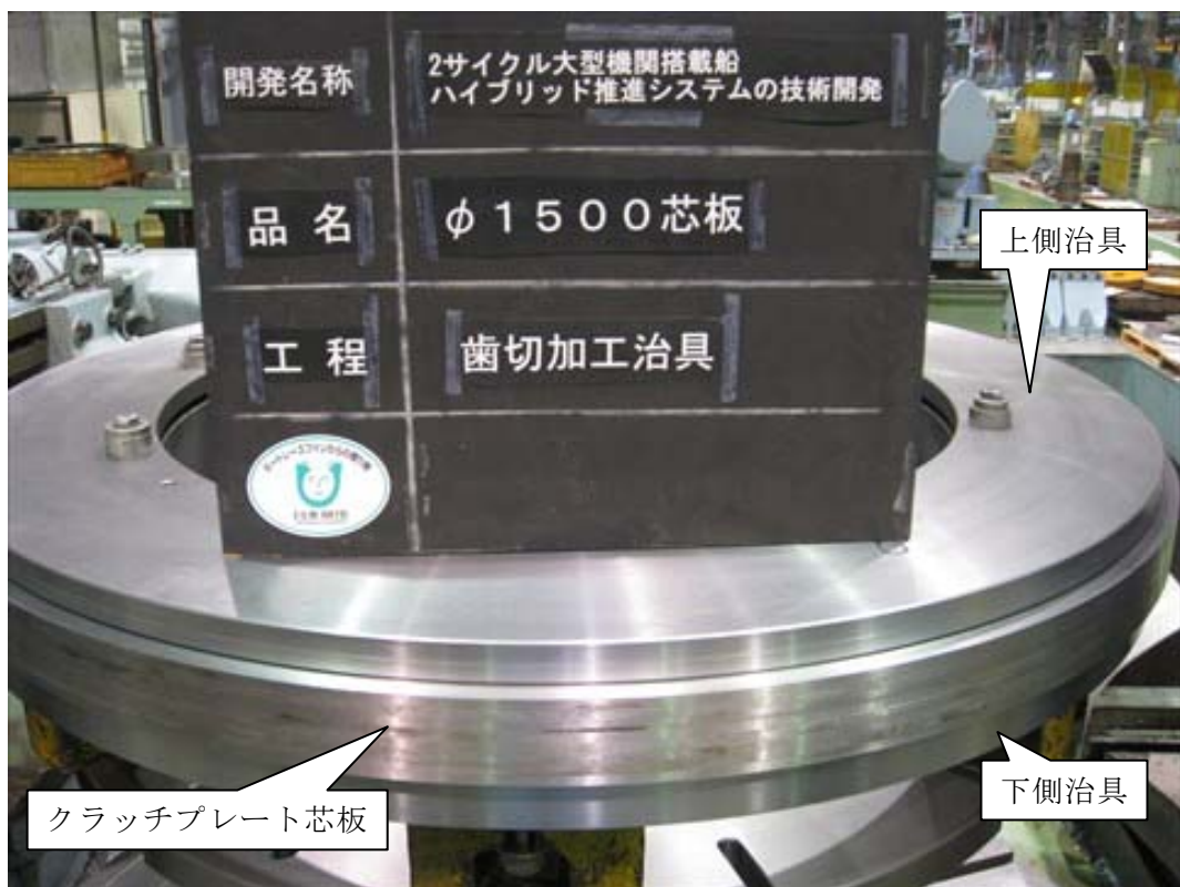
写真11 歯切り加工用治具へのφ1500芯板の取付
