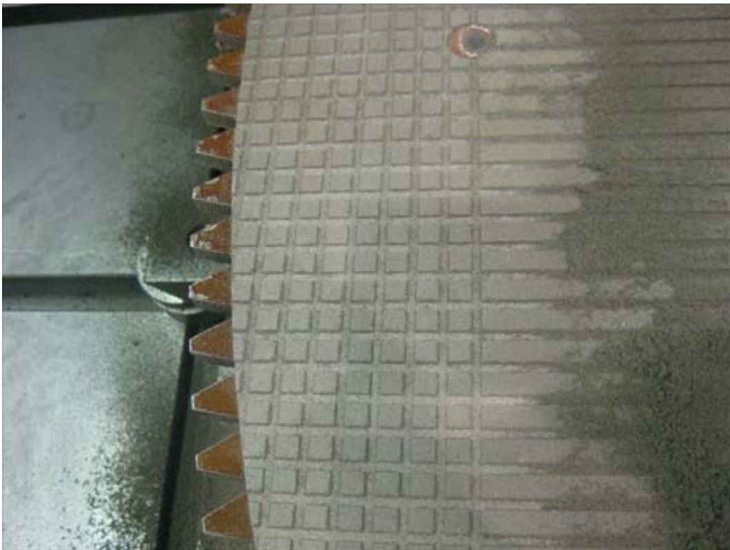
写真 3 1 摩擦面への溝加工中（交差溝拡大）
