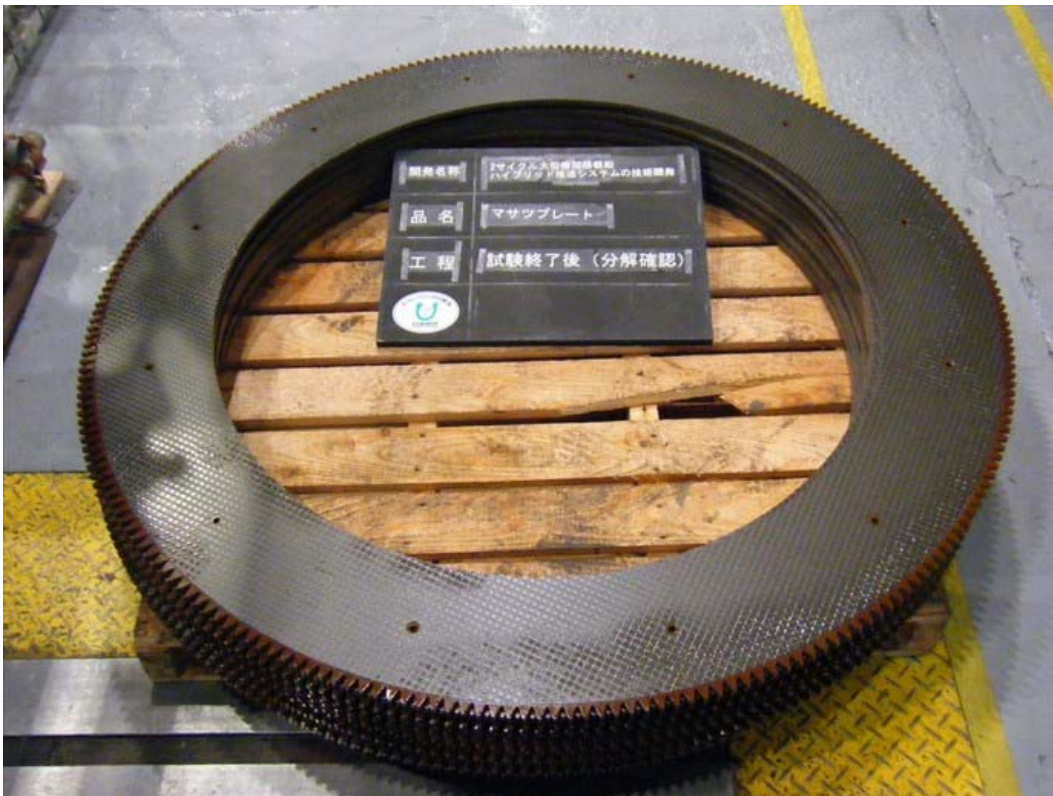
写真92 負荷運転後のクラッチプレート（マサツプレート）
