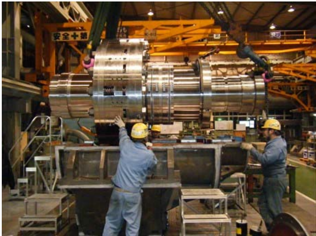
写真 7 5 内部回転体の下ケーシング (HSG-2) への組み込み中
