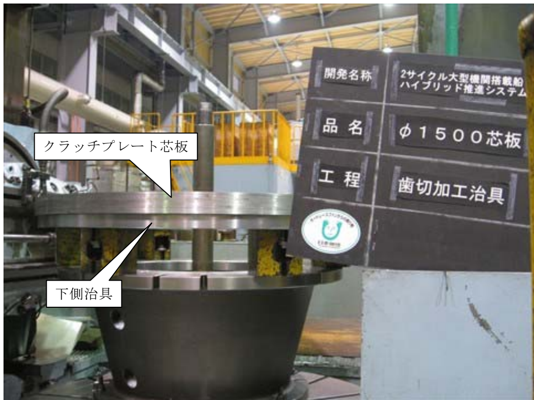
写真10 歯切り加工用治具へのφ1500芯板の取付
