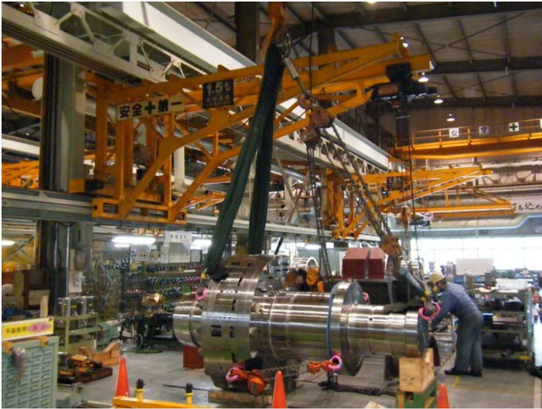
写真 7 3 内部回転体の反転作業完了姿
