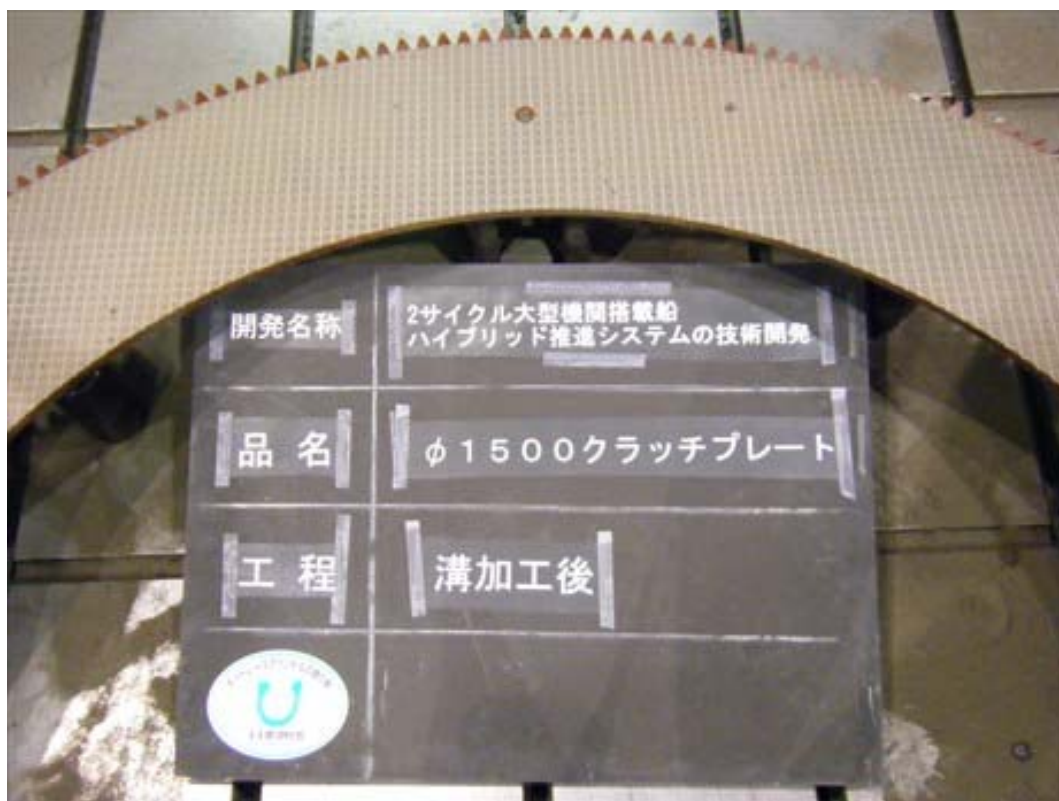
写真 3 3 溝加工後（拡大）
