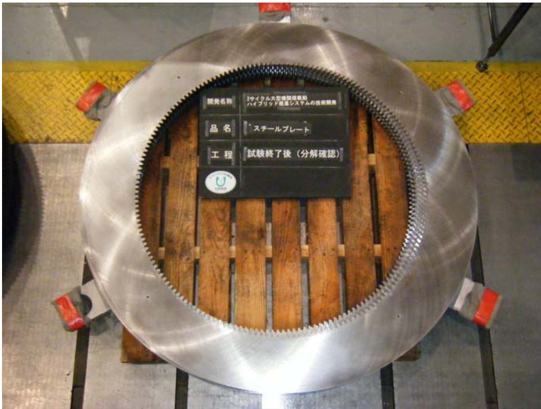
写真 9 5 負荷運転後のクラッチプレート接着面②
