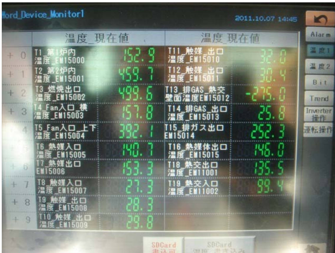
写真 4.44 排ガス熱交換器陸上性能確認試験用温度計指示モニター
