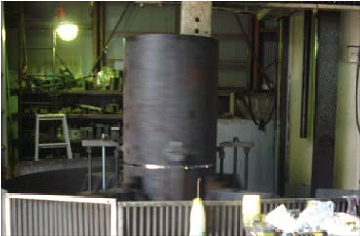
写真 3.33 縦型切削機による外筒の内面切削芯円加工中
