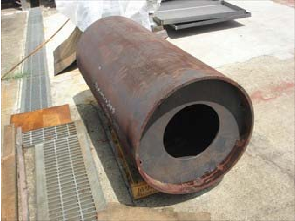
写真 3.32 外筒の焼鈍加工後
