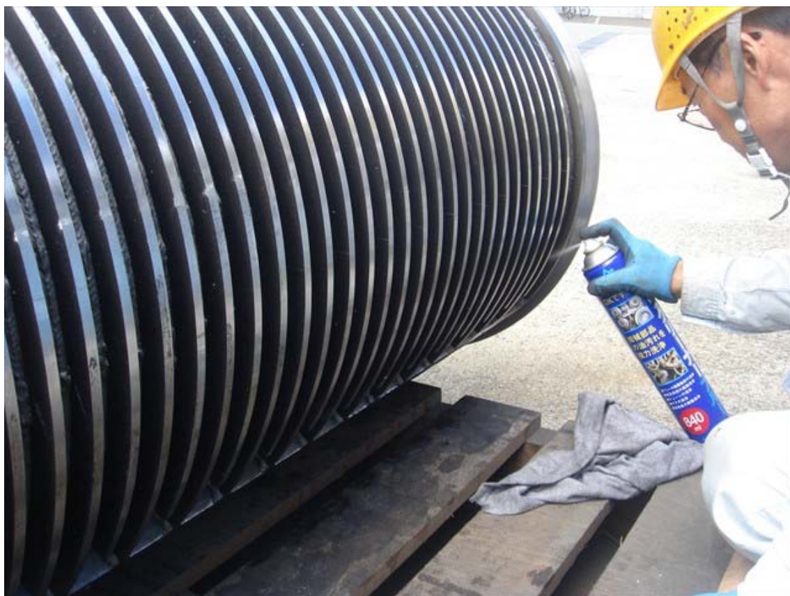
写真 3.38 切削面の清掃作業
