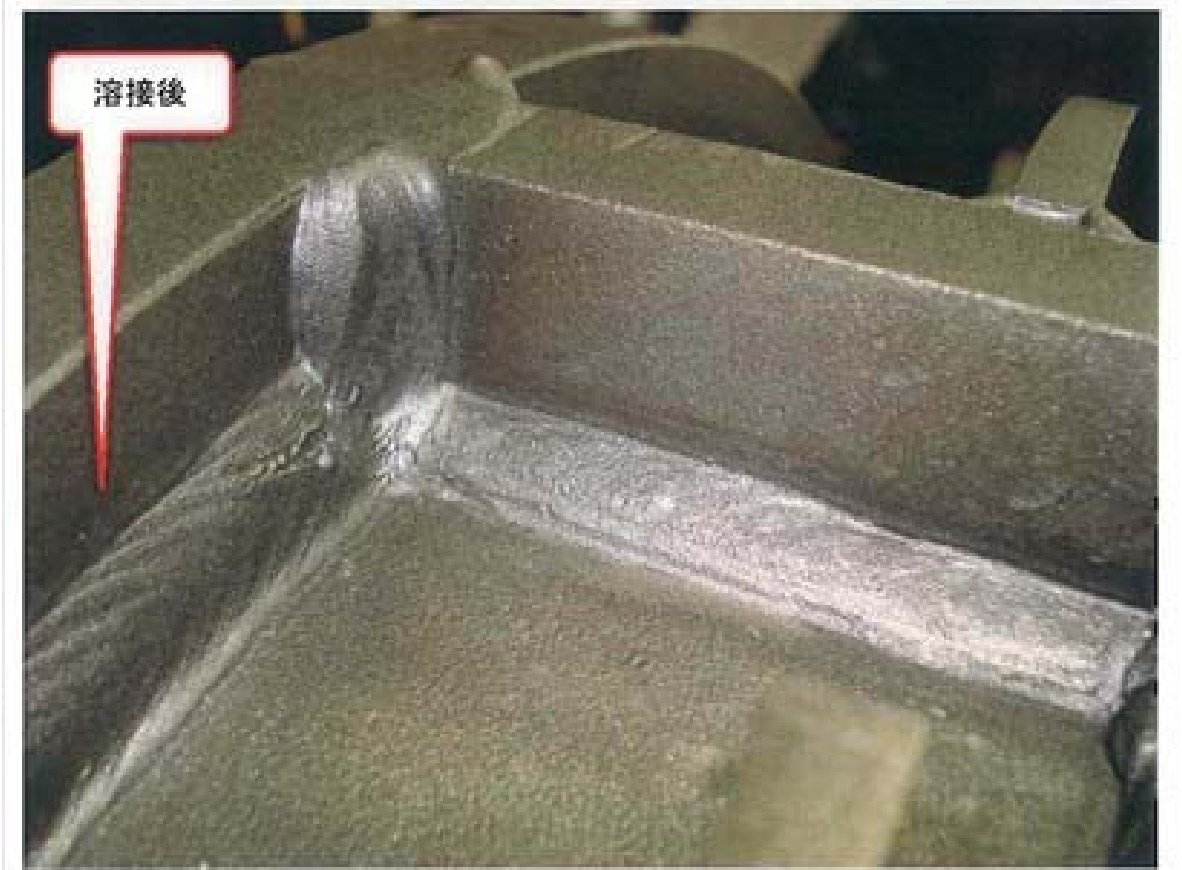
写真 3.30 内筒熱媒油路リング溶接部
