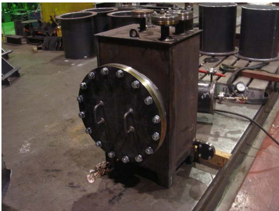
写真 3.39 熱媒油貯タンク耐圧試験
