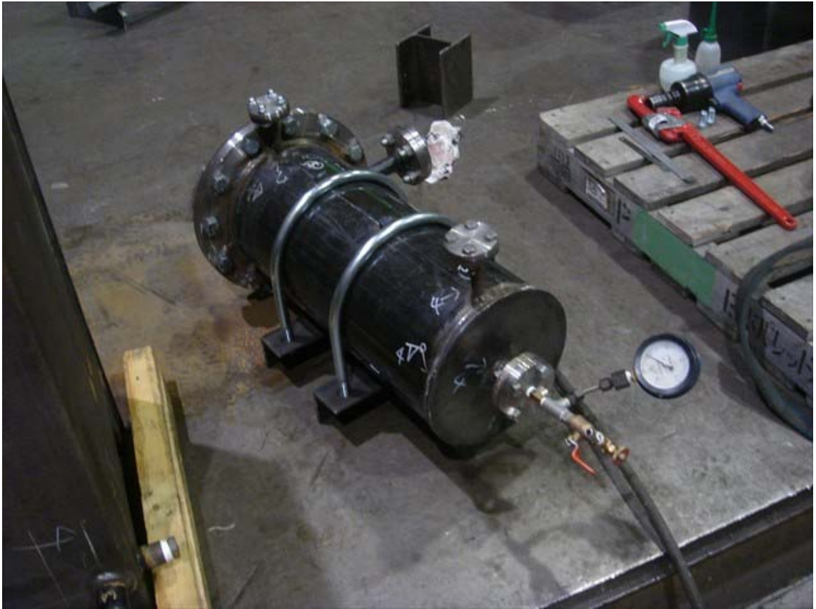
写真 3.40 熱媒油膨張タンク耐圧試験
