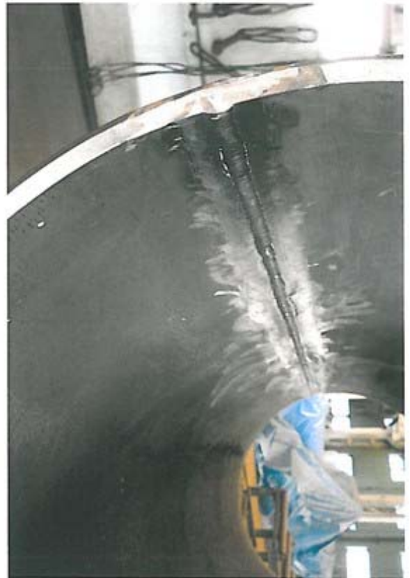
写真 3.29 内筒溶接後ローラーベンダで歪み取り施工
