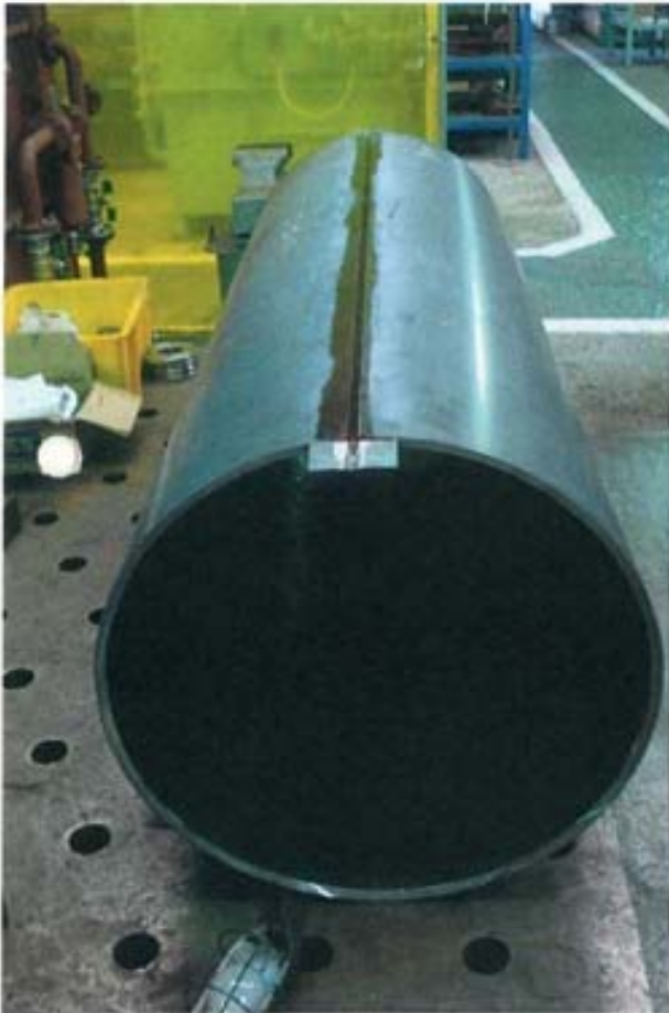
写真 3.28 内筒外部溶接部開先部
