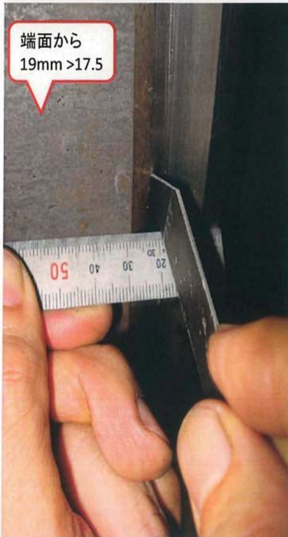
写真 3.34 開先ゲージによる計測
