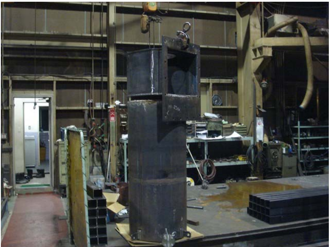
写真 3.41 排ガス熱交換器本体の耐圧試験
