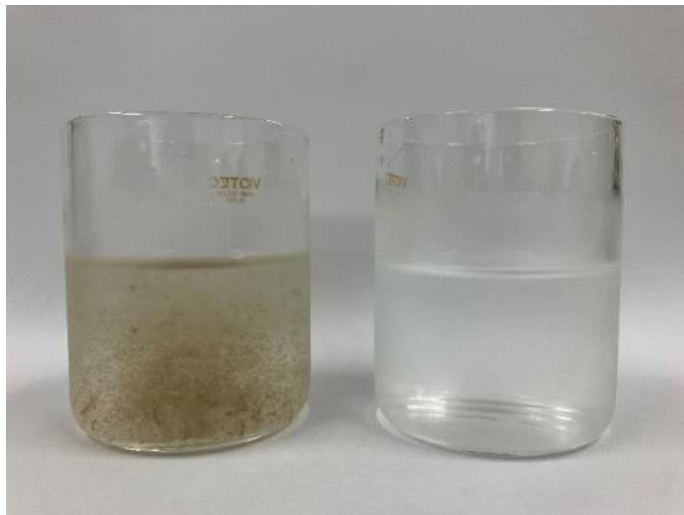
図 5-12 ROV から吸引したデブリを含む海水とデブリ回収装置の排水
