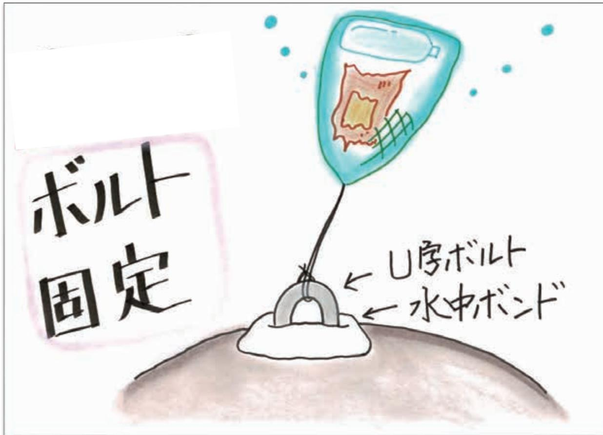
子囊班がでたコンブをスポアバッグに詰め、岩場に設置することで、そこから種が周りに広がります。バッグが流されないように、岩盤に水中ボンドとU字ボルトを使って固定します。
