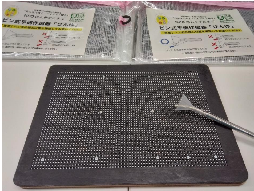
図 11 ピン式平面作図器「びん作」 (表面に「あ」の文字)
