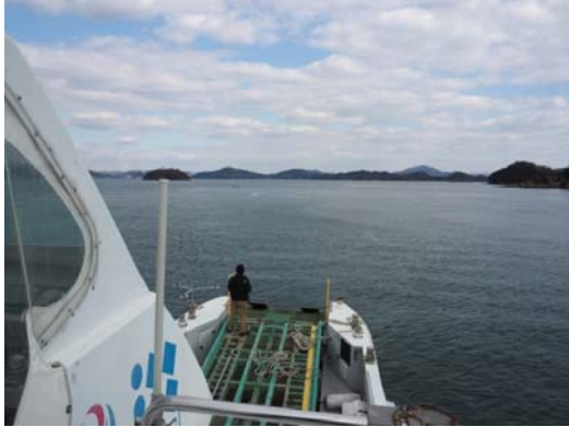
甲板上の操船者によるタブレット操船
