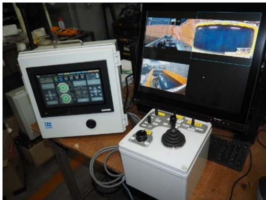
遠隔操船用ジョイスティックシステム（陸上側）
