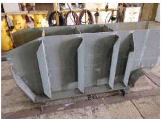
エンジンベッド組立
