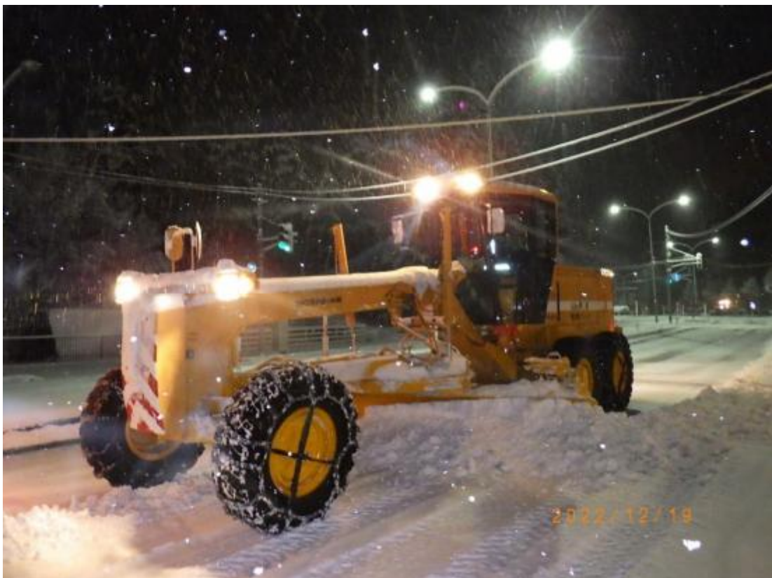
図表 付ー３ グレーダでの除雪作業
