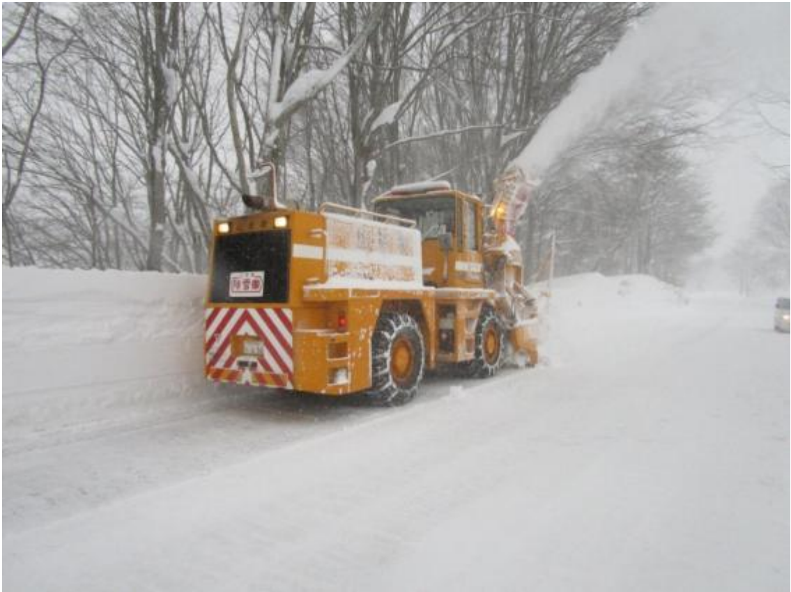
図表 付ー４ ロータリでの除雪作業
