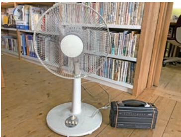
250W のポータブル電源。これで6時間は扇風機を回すことができる
