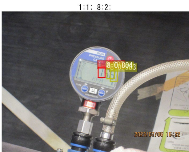
図 4.2-4 AI によるゲージ数値認識（誤認識&未認識）結果（一例）
