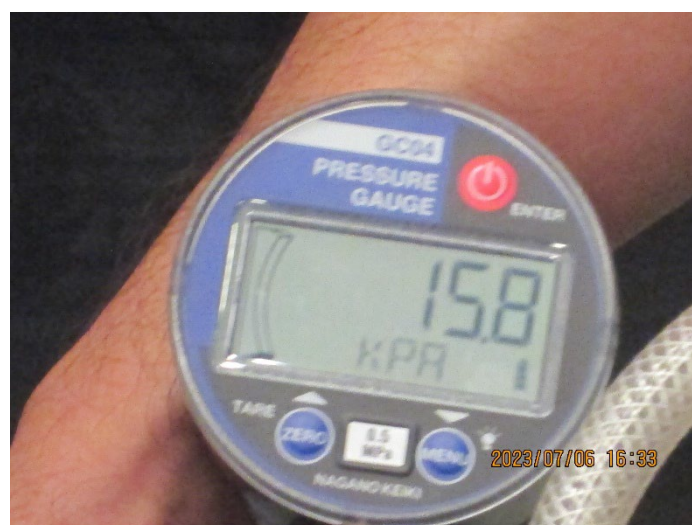
図 4.2-1 膨脹状態での点検（ゲージ読み取り作業）
