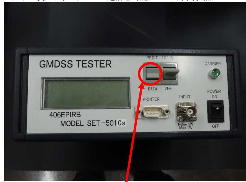
SET-501CSVモデル(試作品)シーソーススイッチ
