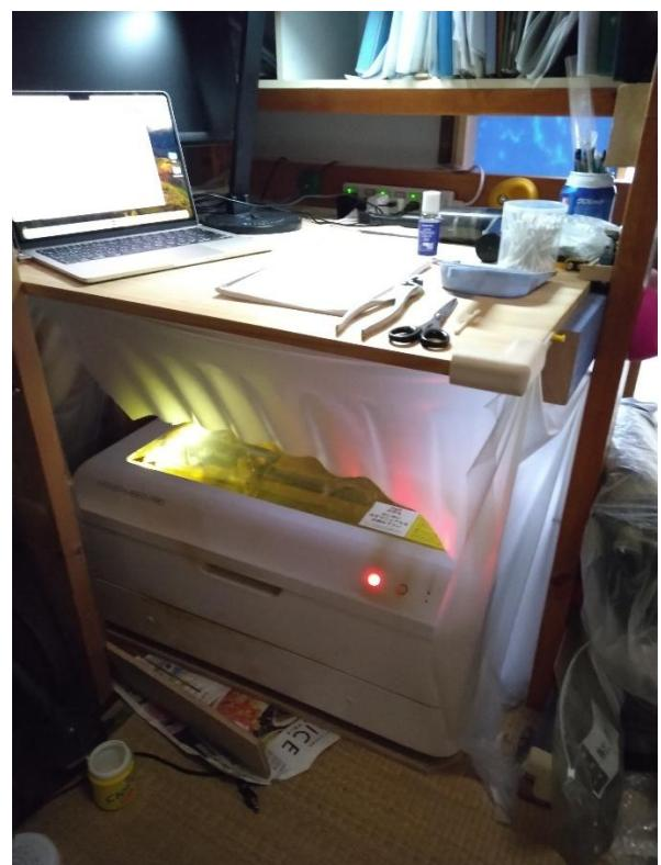
ぴん作の製作に向けて、備品として新たに smartDIYs 社 Etcher Laser Pro を 1 台購入させて頂いた。本機器はリーズナブルな価格帯でありながら本格的な集塵・脱臭フィルターを備えた唯一の機器であるので選定した。実際に使用すると室内側に臭いや粉塵の漏れが発生することが分かったので、設置環境をビニルシートで囲い、背面側に換気扇を設置することで簡易的な局所排気装置内で使用するように周辺整備を行った。
