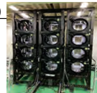
大型ソーラシミュレータ ⇒発電性能評価
