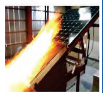
燃焼性試験装置 ⇒耐久性評価
